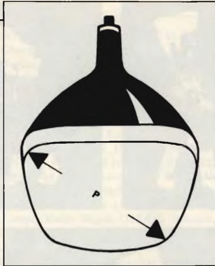
Fig. 12 - Quali sono le misure reali di un tubo a raggi catodici? La misura in pollici si riferisce sempre alla diagonale. Ecco le principali misure: 9" = 229 mm, quadro = 183 x 138 mm 2 . 12" = 305 mm = 244 x 184 mm 2 . 14" = 356 mm = 286 x 214 mm 2 . 17" = 432 mm = 345 x 260 mm 2 . 20" = 508 mm = 406 x 306 mm 2 . 21" = 534 mm = 426 x 320 mm 2 . 22" = 559 mm = 447 x 337 mm 2 . 24" = 610 mm = 488 x 366 mm 2 . 26" = 661 mm = 529 x 399 mm 2 . 27" = 686 mm = 548 x 471 mm 2 .
