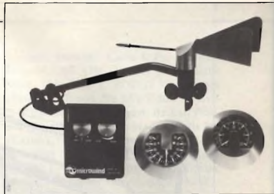
Fig. 5 - Semplici apparecchi elettronici per la misura della velocità e della direzione del vento, per piccole imbarcazioni a vela.
