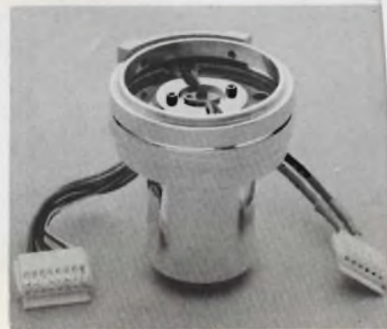
Il cuore del VTR FUNAI: il gruppo testine rotanti miniaturizzato.
