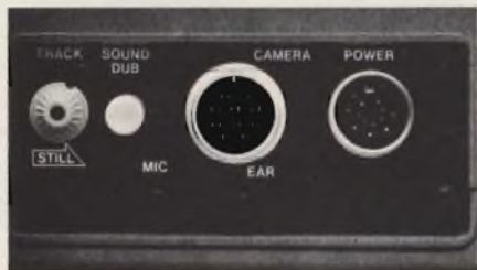
Il piccolo pannello laterale con gli attacchi per la camera, l'alimentatore e gli altri comandi.
