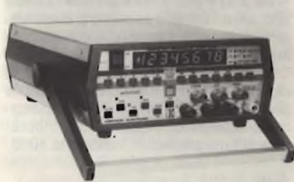
Multimetro digitale a 5 1/2 cifre controllato da microprocessore
