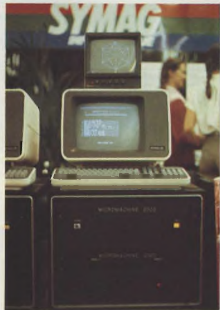
Fig. 2 - La Micromachine 2000 può essere equipaggiata di 2 floppy da 8" 512 Mbyte con cartridge per back-up. In monoutente fa uso del CP/M o dell'I/O/S mentre in multiutente (fino a 8) usa l'MP/M o l'OASIS. Il bus S100 permette facilità di espansione, ad esempio con l'inserzione di una carta grafica ad elevata risoluzione.
