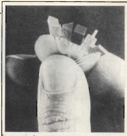
Fig. 2 - La disponibilità di incapsulaggi diversi per i LED permette ora una maggior versatilità nelle applicazioni come indicatori. Questi prodotti Sharp sono già disponibili in Inghilterra tramite la CRP Electronics.
