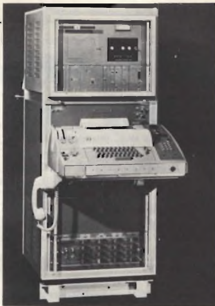
Fig. 14 - Un modernissimo complesso terminale per comunicazioni marittime via satellite, il MARISTAR. Frequenza di lavoro TX 1636,5 + 1645 MHz, RX 1535 + 1543,5 MHz. Antenna con riflettore del diametro di 1,22 m. Potenza di picco TX 40 W.
