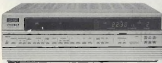
Fig. 4 - Saba VR 6024: adotta il sistema VHS. La tastiera è a comandi logici: è possibile la presintonia di 32 canali TV, avanti e indietro, lento e veloce, l'avanzamento per fotogrammi singoli. Il timer consente la programmazione della macchina per 8 interventi in 14 giorni. Il 6024 adotta il Dolby C telecomandabile a raggi infrarossi. È possibile il collegamento di una cuffia.
