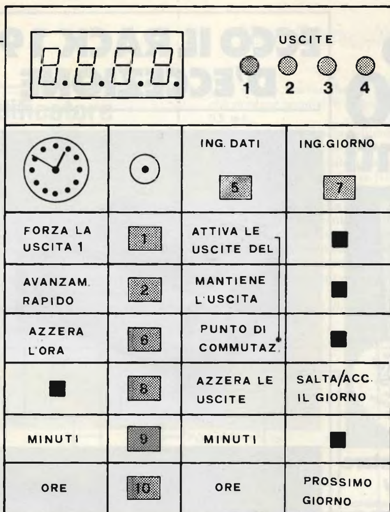
Fig. 5 - "MASCERA" per la tastiera del timer elettronico da fissare direttamente sul circuito stampato, riportato in fig. 4.
