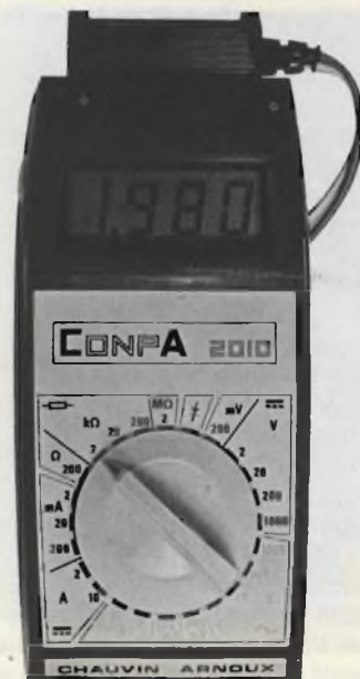
Multimetro digitale a cristalli liquidi con una precisione base di 0,1%.
