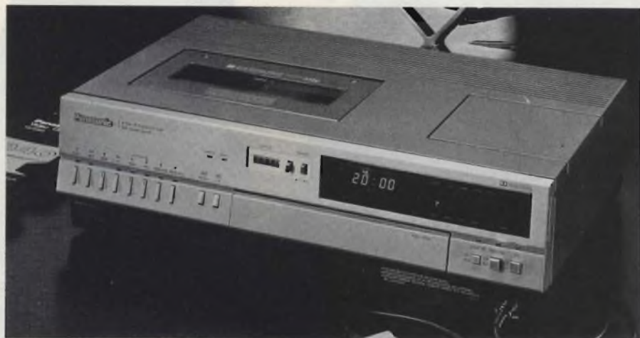
Fig. 1 - Panasonic NV 7000: si tratta di un VHS domestico con tastiera elettronica, possibilità di ricerca veloce e fermo immagine. Adotta il Dolby e dispone di preselezione di 12 programmi e di timer per la preprogrammazione della macchina (8 registrazioni in 14 giorni). È possibile il telecomando a filo: il prezzo è di circa 1.550.000 lire.
