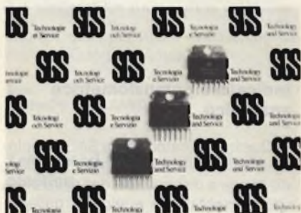
Chip per la deflessione verticale in grado di pilotare direttamente i gioghi dei televisori.
