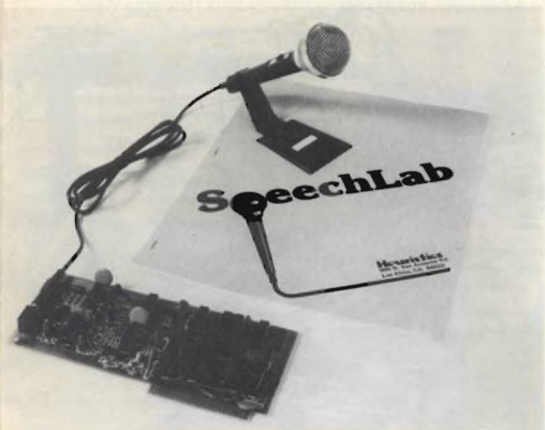
Una piastra della Heuristics, capace di identificare 64 parole, purchè sia la stessa persona a registrarle ed a pronunciarle.
