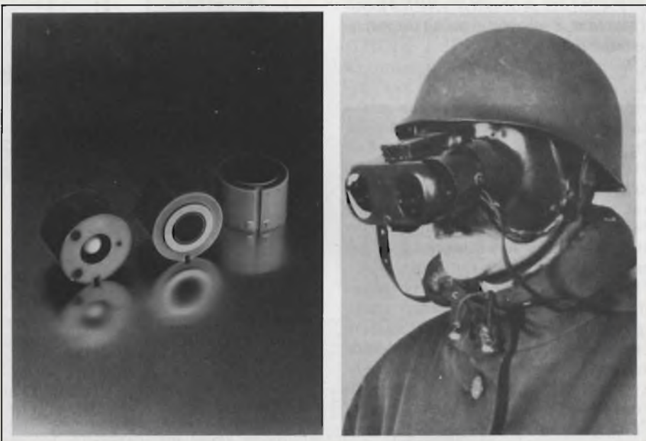
Fig. 7 - A sinistra: tubo intensificatore d'immagine della seconda generazione XX1410. Possiede la piastra a microcanali. La finestra d'ingresso (18 mm Ø) è in fibra ottica onde consentire il migliore trasferimento dell'immagine del sistema ottico sulla superficie del fotocatodo. All'uscita, l'immagine con una luminosità 15.000 volte maggiore che all'ingresso, viene raddrizzata (e cioè ruotata di 180°) mediante un "twister" a fibre ottiche. Questo tubo è impiegato di preferenza negli occhiali per visione notturna come indicato in basso. Gli occhiali pesano 900 g.
