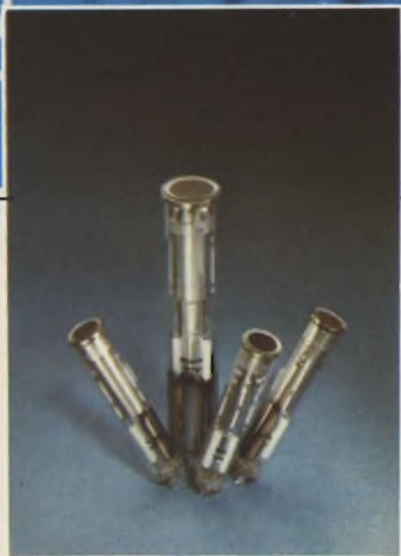
Fig. 2 - Newvicon XQ1274 da 2/3" (ultimo a destra). È lungo 108 mm. Lo strato fotoconduttore è formato da tellururo di cadmio e zinco. La deflessione e la focalizzazione sono magnetiche.
