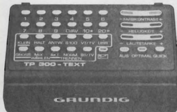
Fig. 22 - Telecomando TP 300 TEXT. Se questo viene fornito col decoder BT, il tasto BT/TV è sbloccato.
