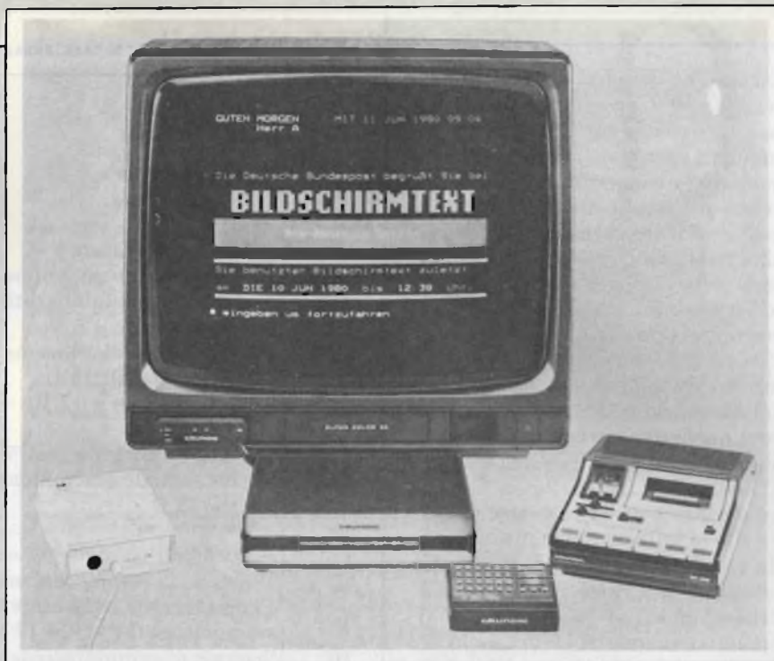
Fig. 19 - Gli apparecchi necessari per il funzionamento BT, il decoder BT è collegato al televisore tramite il vano universale, il registratore a cassette mono serve per la memorizzazione a lungo termine.
