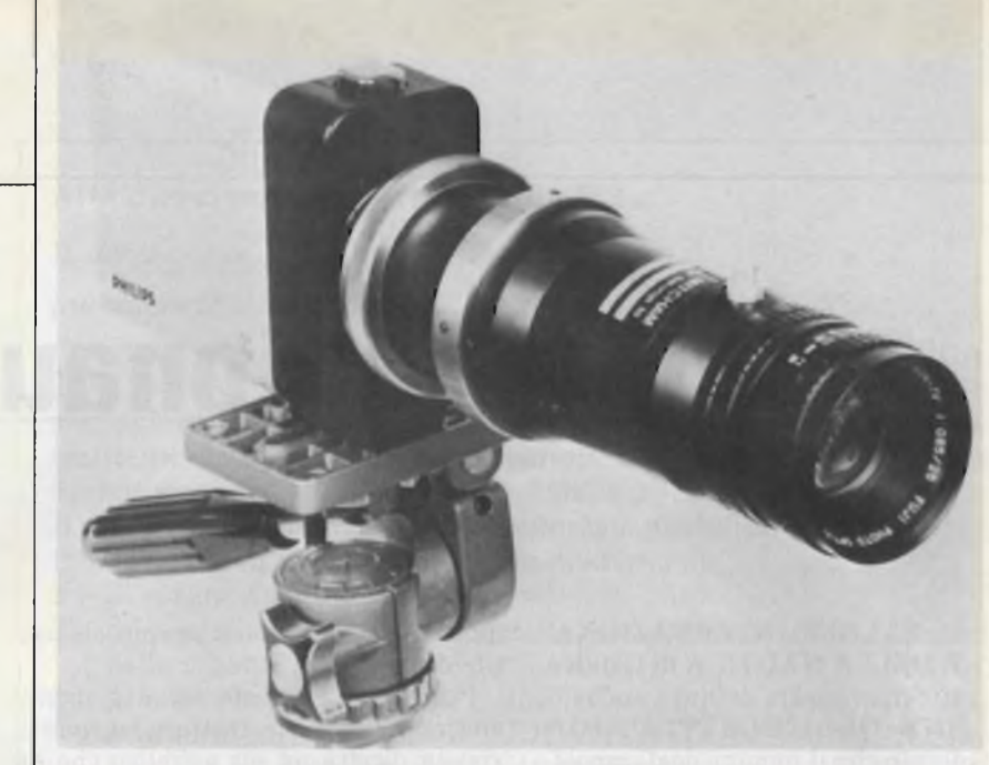
Fig. 8 - Esempio di telecamera con tubo da ripresa TV "intensificato". In questo caso, il tubo intensificatore (il tipo XX1500TV) è completo e si trova all'esterno e davanti al tubo da ripresa TV, un Newvicon standard. L'accoppiamento e la messa a fuoco dell'immagine sul target del tubo da ripresa TV è effettuato mediante un adattatore ottico.
