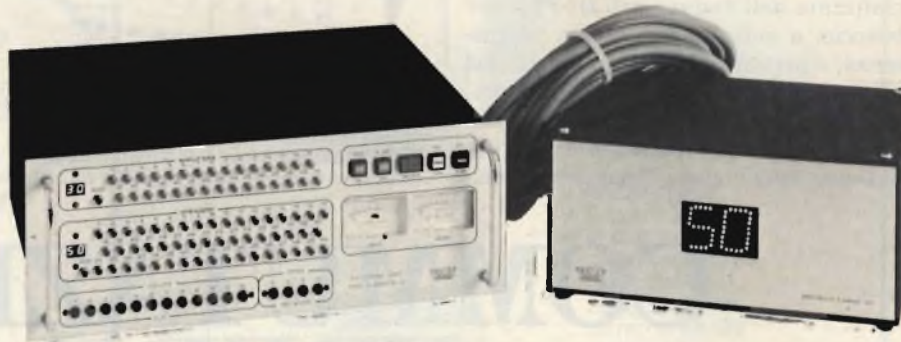
Fig. 4 - Anche se nella produzione Abster vi sono modelli ancora più ricchi di commutazioni, il modello Z 3050/12-4, rappresenta già un sistema ragguardevole per possibilità, adatto per auditori importanti. A ciascuno dei trenta amplificatori connessi alle entrate, si possono connettere tutte le coppie di casse acustiche (cinquanta!) commutabili, e viceversa.
