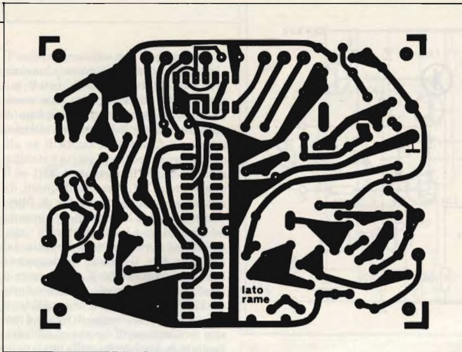
Fig. 5 - Circuito stampato dell'induttanzimetro visto dal lato rame in scala 1:1. È bene che la massa venga ingrossata e che non formi spire chiuse su se stesse.
