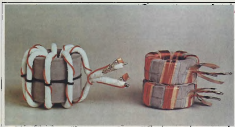
Fotografia di trasformatori di adattamento a larga banda. A sinistra: trasformatore a linea di trasmissione. A destra: trasformatore normale a filo.
