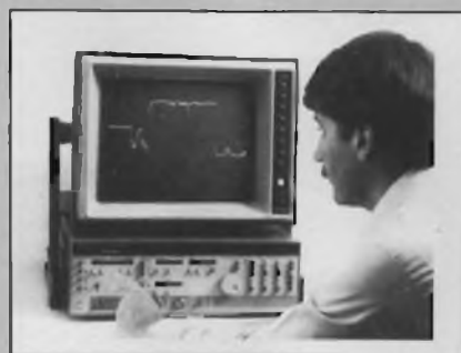
Registratore di forme d'onda a memoria digitale dotato di convertitore A/D ad alta velocità.
