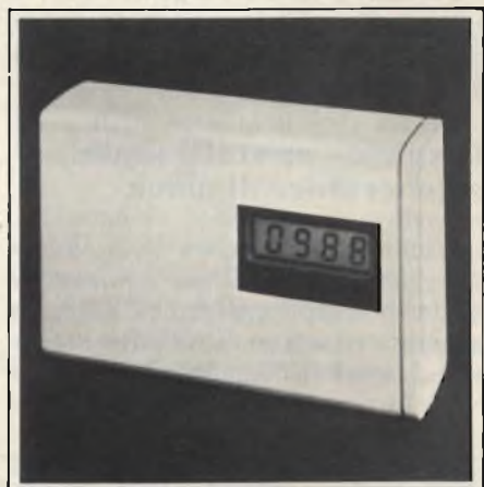
Fig. 6 - Prototipo del barometro digitale a cristalli liquidi
