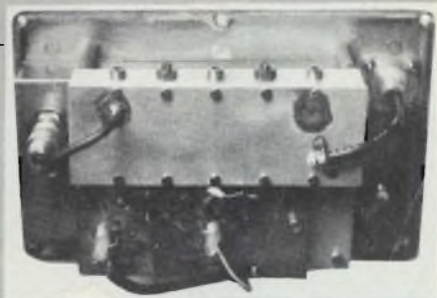
Fig. 4 - Modulo convertitore pronto per l'impiego. Si noti l'importante schermatura totale.
