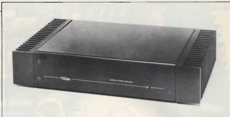
L'amplificatore finale da 30 + 30 W si presenta in forma elegante grazie all'impiego di un contenitore commerciale.
