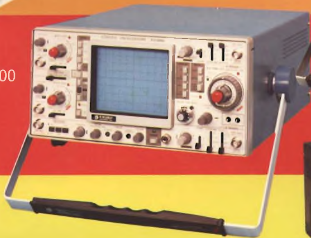
Oscilloscopio programmabile mod. COS 5030 PG a 35 MHz con possibilità di 22 ingressi a 96 steps - compatibili con personal computer.
