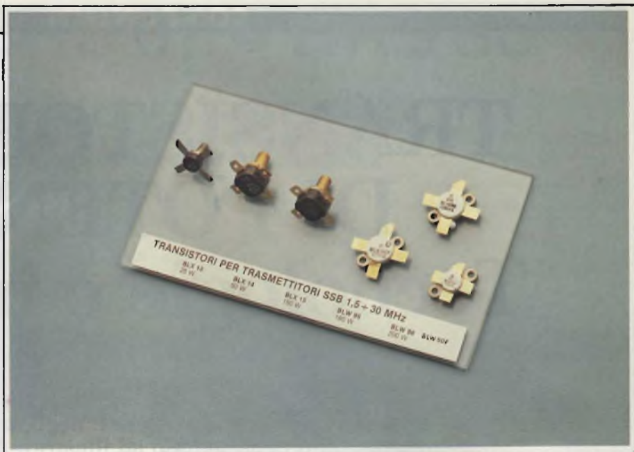
Fig. 1 - Tipici transistori di potenza per impieghi in amplificatori lineari a larga banda (S.S.B.).
