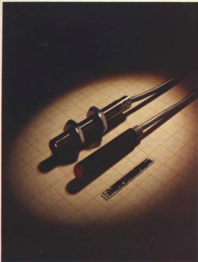
Fig. 1 - Esempio di rivelatore di prossimità ad induzione realizzato mediante circuito integrato ibrido a film spesso (indicato in basso). La piastrina in ceramica dov'è realizzato il circuito del rivelatore, può essere inserita in un tubo filettato di plastica o di metallo.
