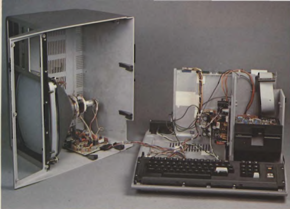
Aprendo il TRS 80 Model III questo si divide in due parti: il coperchio a cui restano attaccati il monitor video con il suo circuito elettronico di comando da una parte e tutto il resto dall'altra. Il contenitore è interamente realizzato in materiale plastico resistente.
