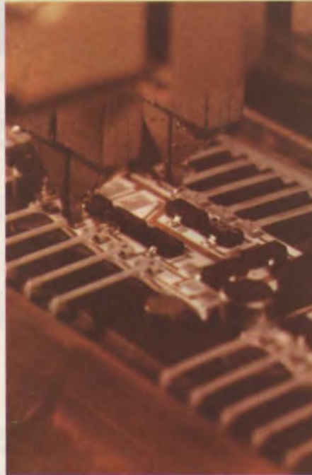
Fig. 3 - Fase di saldatura dei componenti sul substrato.
