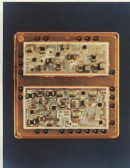
Fig. 1 - Circuito integrato ibrido a film sottile per telecomunicazioni. Si notino i condensatori chip ceramici multistrato, i quali non sono altro che più condensatori singoli collegati in parallelo. In questi condensatori, le armature sono in parallelo e separate tra loro da un dielettrico in ceramica.
