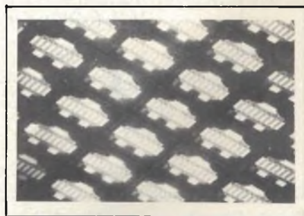
Fig. 7b - Da uno stesso wafer di GaAs con diametro di circa 2" è possibile ottenere più di un centinaio di chip di potenza.
