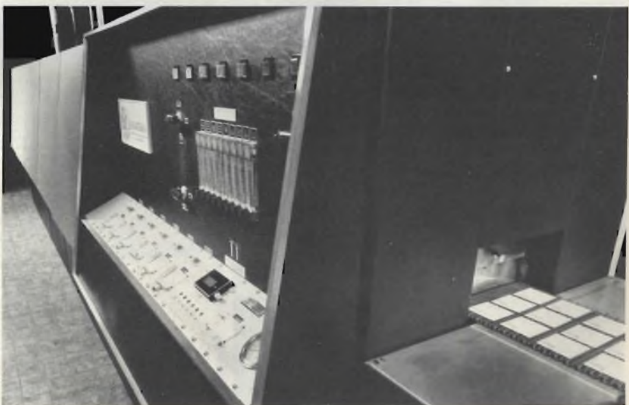
Fig. 5 - Forno a sette zone per la deposizione della pasta conduttrice necessaria per la realizzazione di un circuito ibrido a film spesso. L'uniformità delle caratteristiche elettriche e meccaniche di questi circuiti richiede molte fasi di controllo.
