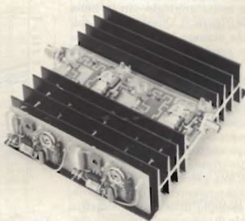
Esempio di applicazione della tecnica delle stripline in un amplificatore di potenza a larga banda (480 ÷ 860 MHz). Di fianco, sul radiatore di calore si può vedere l'unità che polarizza i transistori di potenza BLW32/33.
