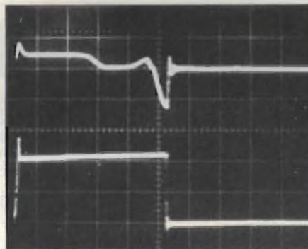
Fig. 7 - Andamento della corrente di base (sopra) e della corrente di collettore (sotto) di un transistor ad alta tensione per commutazione veloce ESM 1015 pilotato dal circuito descritto in questo articolo ( I_c con 4 A/div, I_B con 4 mA/div. Base dei tempi: 2 \mu s/div).
