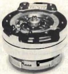
Fig. 2 - Tamburo portatestine. È più basso rispetto ai tamburi dei videoregistratori precedenti. Il diametro è rimasto però invariato.
