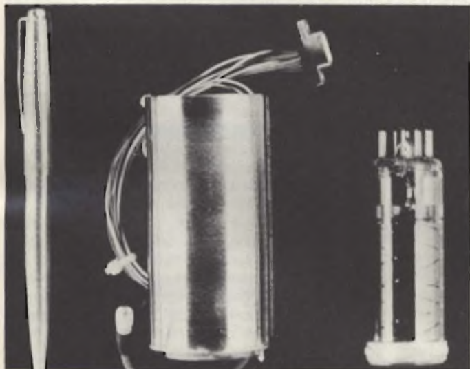
Fig. 1 - Versione accorciata di un tubo da ripresa da 1 pollice (Z 7803 General Electric). La focalizzazione elettrostatica, la deflessione è magnetica.
