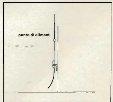
Fig. 6a - Si illustra un'altra possibilità di errore: con questa disposizione le onde vengono assorbite dal palo e non dall'elemento attivo.
