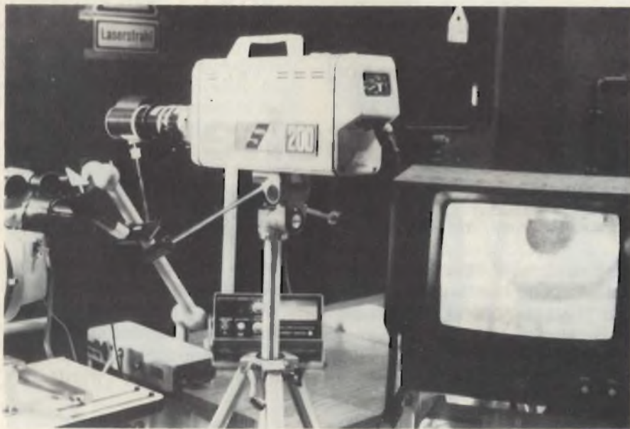
Fig. 2 - Collegamento di una telecamera "high speed" ad un fotocoagulatore laser per lo studio delle reazioni laser. (Foto: Köhler)
