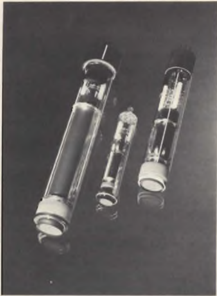
Alcuni tipi di tubi da ripresa Vidicon e Plumbicon. I Vidicon sono disponibili in diametri da 1 pollice e 2/3 di pollice. I Plumbicon da 1-1/4 di pollice a 2/3 di pollice sono i tubi da ripresa ideali per la televisione a colori.
