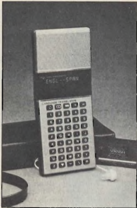
Fig. 6 - Il Language Translator della Texas è un traduttore elettronico tascabile in grado di visualizzare e contemporaneamente pronunciare le parole nella lingua relativa al modulo scelto.
