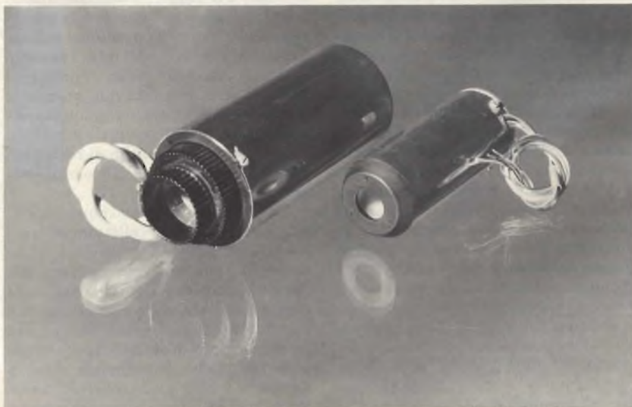
Esempi di gioghi di deflessione e di focalizzazione di tubi per ripresa TV. In questi ultimi tempi la focalizzazione viene realizzata per via elettrostatica.
