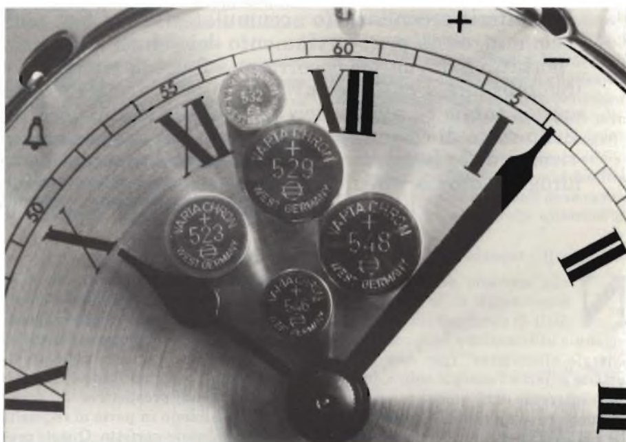
Fig. 4 - Le pile a bottone devono essere conservate in ambiente fresco e secco. Possono essere tenute in frigorifero solo se non c'è pericolo di condensa. Per inserire la pila nell'orologio occorre usare una pinzetta in plastica, perché cortocircuiti anche brevi diminuiscono molto la capacità. Bisogna evitare anche di inumidire la pila con il sudore della mani, perché la resistenza del sudore potrebbe scaricare ulteriormente la pila senza contare i pericoli di corrosione.
