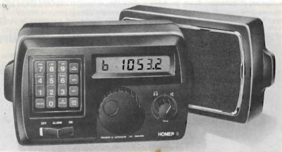
Fig. 4 - Uno fra i più completi radiorecettori per la ricezione della gamma 50 kHz \div 25 MHz a salti di 0,1 kHz, doppia conversione di frequenza, memorizzazione di frequenze e dispositivi di allarme. Si tratta del modello HOMER 5.
