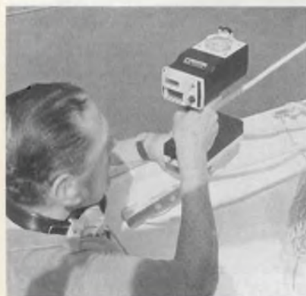
Fig. 1 - Impiego del radiogoniometro portatile SEABEAM, a bordo di un automezzo.
