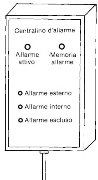
Fig. 1 - Aspetto esterno del centralino d'allarme nel suo mobiletto in plastica con pannello frontale in alluminio.
