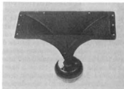
Fig. 2 - Tromba per toni medi impiegata nell'esempio costruttivo (tipo HTM 10.27).
