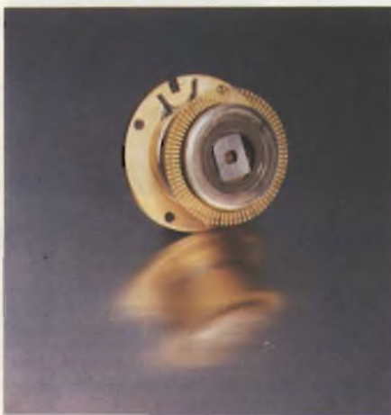
Contenitore raffreddato per via termoelettrica. Dentro si trova il rivelatore di infrarosso formato da 64 elementi. Lavora nella finestra 3 ÷ 5 \mu\text{m} . I connettori radiali che si vedono intorno alla finestra sono collegati agli elementi del rivelatore; i due spinotti che si vedono a sinistra vicino alla base di montaggio vanno collegati al sistema del refrigeratore.
