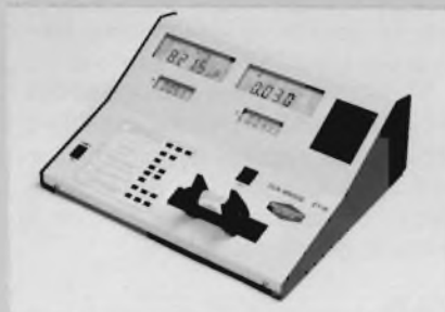
Ponte CLR automatico.
