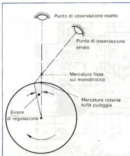
Fig. 2 - Lettura errata a causa del parallasse.
