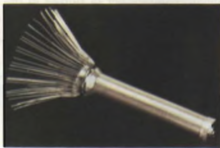
Fig. 5 - I terminali relativi ai vari elementi di cui può essere formato un rivelatore di infrarossi percorrono internamente la parete di vetro del dewar dalla quale fuoriescono per essere collegati alla parte elettronica del sistema.
