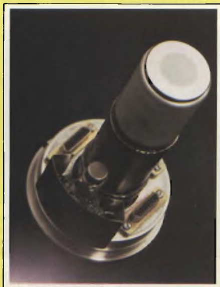
Vaso "dewar" M3RPY per il raffreddamento di un rivelatore di infrarosso formato da 55 elementi. La finestra è formata da germanio antiriflettente e può ricevere radiazioni infrarosse comprese tra 8 e 13 \mu\text{m} .
