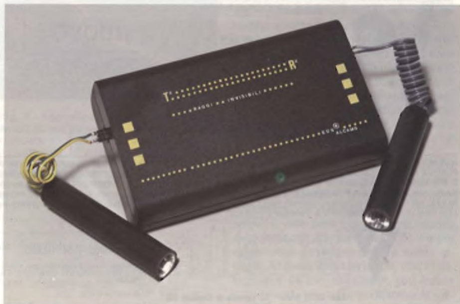
Foto del sistema di protezione a raggi infrarossi a realizzazione ultimata.
