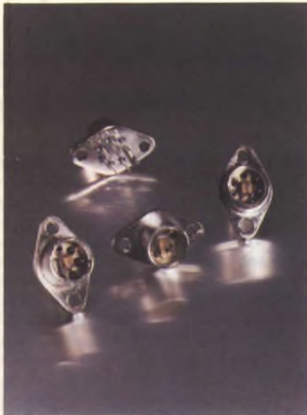
Rivelatori di radiazioni infrarosse M4RPY ad un solo elemento. Possono lavorare nella finestra compresa tra 3 e 5 \mu\text{m} . Il raffreddatore è il tipo termoelettrico a due stadi. Il contenitore è riempito con xenon. La finestra è di zaffiro.
