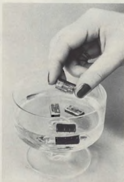
Relè miniatura a tenuta d'acqua.
