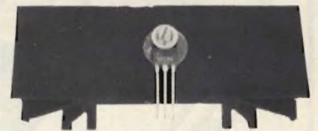
Fig. 5 - Esempio di fissaggio isolato a vite del contenitore TO-126.
