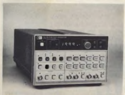
Generatore di funzioni in grado di fornire forma d'onda da 0,001 Hz a 20 MHz.
