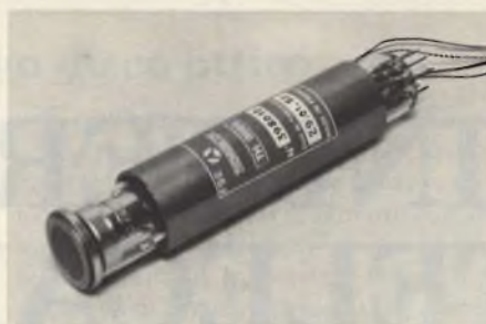
Fig. 2 - Aspetto esterno di un Pyricon.
