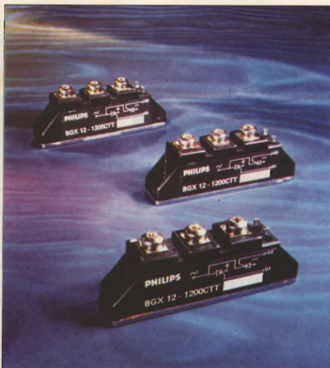
Fig. 3 - Stack dei tiristori, formato da tre moduli BGX12 di potenza. Ogni modulo contiene due tiristori, ed avendo ciascuno una base di montaggio completamente isolata, sarà possibile montare tutti e tre i moduli su un unico dissipatore di calore.
