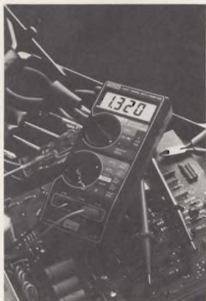
DMM a TRMS con rivelazione delle temperature.
