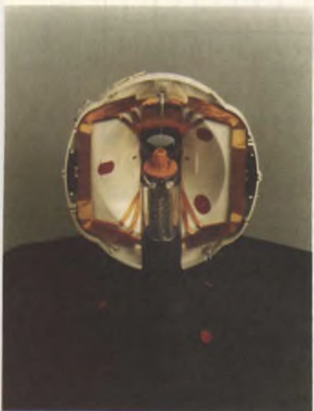
Fig. 2 - Giogo di deflessione e cinescopio del sistema 30AX. Grazie a queste tre tacche cilindriche che emergono dal cono del cinescopio e che vanno a incastrarsi nei tre corrispondenti incavi praticati sul supporto del giogo (nella figura indicati in rosso per maggior chiarezza), il giogo può assumere una posizione ben definita rispetto al tubo e tale da eliminare gli errori della convergenza dinamica. Nella figura si vedono le bobine di deflessione di riga, e in alto e in basso i magneti richiesti per completare le correzioni. Le bobine di quadro si trovano dietro il supporto e sopra di esse viene adagiato il nucleo in ferrite.
