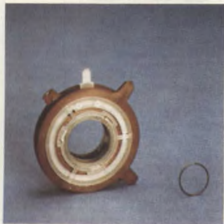
Fig. 1 - Prima dell'introduzione del sistema 30AX, la convergenza statica veniva messa a punto con l'unità multipolare esterna fissata sul collo del cinescopio. Con l'introduzione del sistema 30AX, questo circuito è sostituito da un anellino magnetizzato in sede di collaudo del tubo in maniera da presentare nei confronti dei fasci, campi magnetici a 2, a 4 e a 6 poli, aventi l'intensità e la direzione richiesta dalle esigenze di convergenza statica del tubo in cui è montato.
