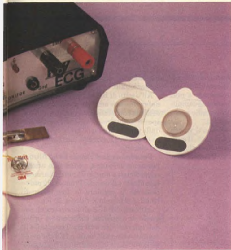
Elettrodi per il rilevamento dei potenziali bioelettrici. A sinistra monitor per il rilevamento della bioelettricità.
