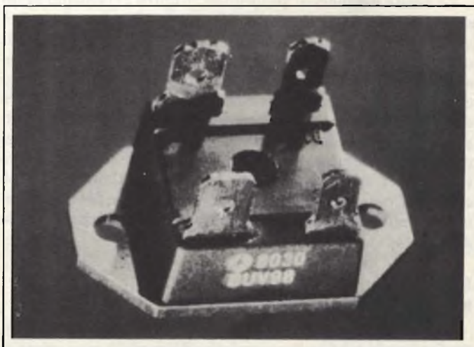
Transistori di potenza Superswitch in contenitore Isotop. Le sigle BUV 98 e BUV 98 A indicano i transistori veloci di potenza per correnti e tensioni elevate che, nei tipi a contenitore TO 3, si chiamavano BUX 98 e BUX 98A.
