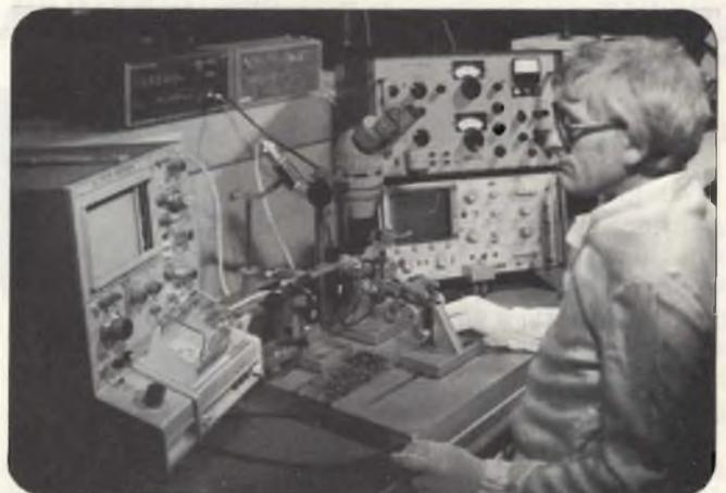
Due fasi nel controllo dei substrati impiegati negli oscillatori a microonde (sopra) ispezione ottica. (sotto) Collaudo.
