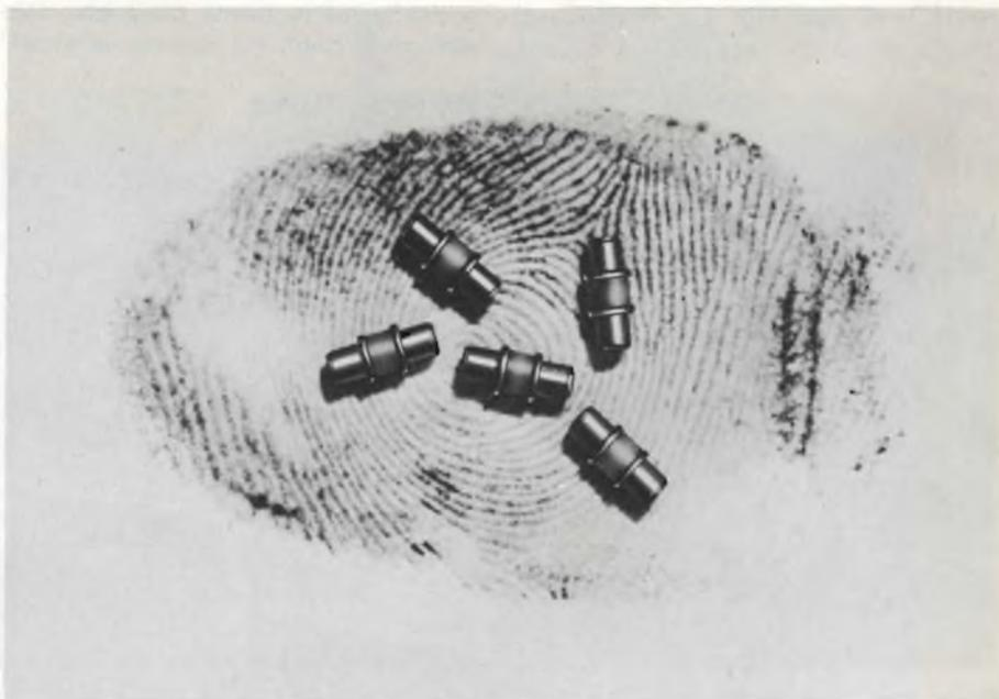
Fig. 5 - Alcuni tipi di diodi Schottky per microonde.
