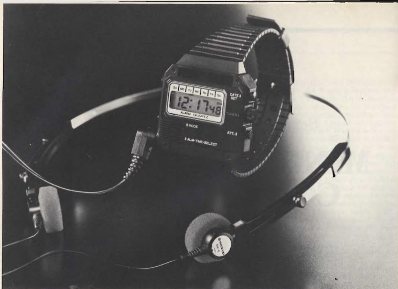
Le versioni TDA 7010 U (solo il chip senza il contenitore) e TDA 7010T (In contenitore miniatura SO 18) consentono di incorporare un ricevitore FM mono all'interno di un orologio da polso.
