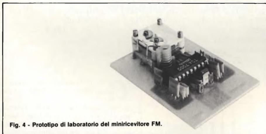
Fig. 4 - Prototipo di laboratorio del miniricevitore FM.
