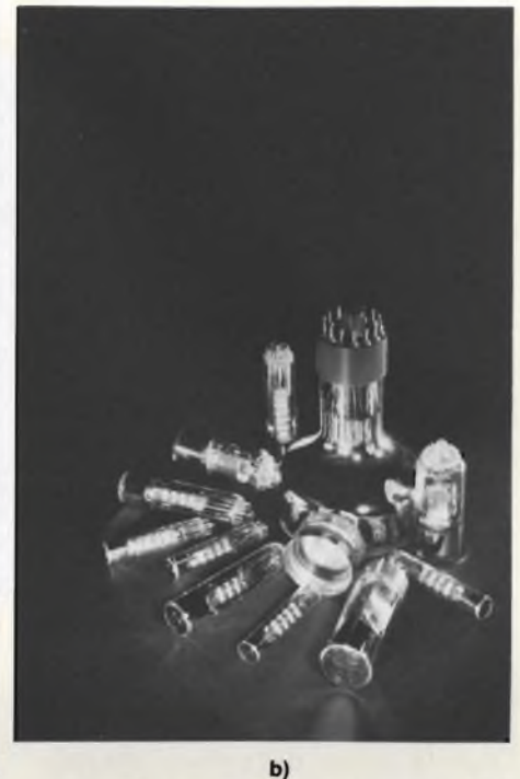
Fig. 2 (a) - Principio di funzionamento di un tubo fotomoltiplicatore. È la presenza di anodi ausiliari (detti dinodi) tra fotocatodo e anodo principale che, grazie al fenomeno della emissione secondaria, permette di "moltiplicare" l'intensità luminosa della radiazione d'ingresso. (b) - Alcuni tipi di fotomoltiplicatori maggiormente impiegati. Al centro si può vedere anche uno scintillatore. Serve a trasformare in un impulso di luce alcune radiazioni invisibili. Viene posto davanti al fotocatodo del fotomoltiplicatore.
