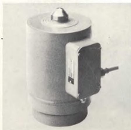
Fig. 20 - Principio di misura di un peso mediante celle di carico. I calibri estensimetrici vengono applicati al centro della cella di carico e collegati in un circuito a ponte.
