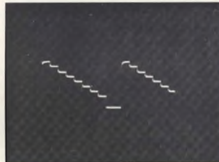
Fig. 9. Come appare il segnale della scala dei grigi sullo schermo dell'oscilloscopio.
