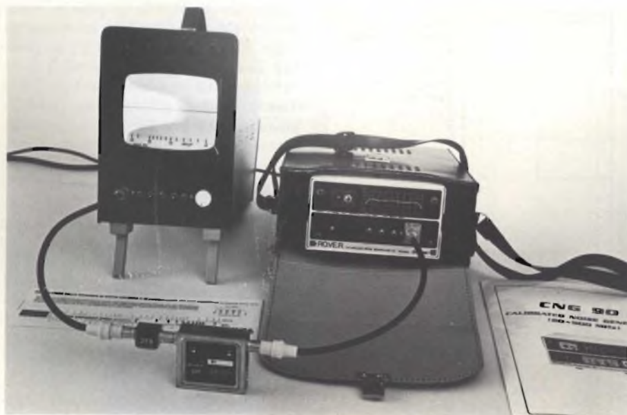
Fig. 1 - CNG 90 utilizzato in questo caso per il controllo della rete di distribuzione.
