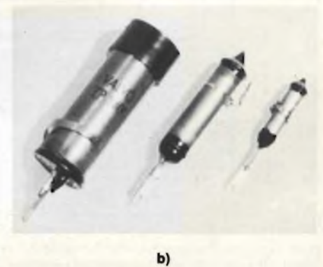
Fig. 1 (a) - Struttura di principio di un tubo Geiger Müller. È la ionizzazione (e la conseguente corrente elettrica) prodotta dall'impatto della radiazione con gli atomi del gas che permette di evidenziare la presenza della radiazione. (b) - Tipi commerciali di tubi Geiger Müller.
