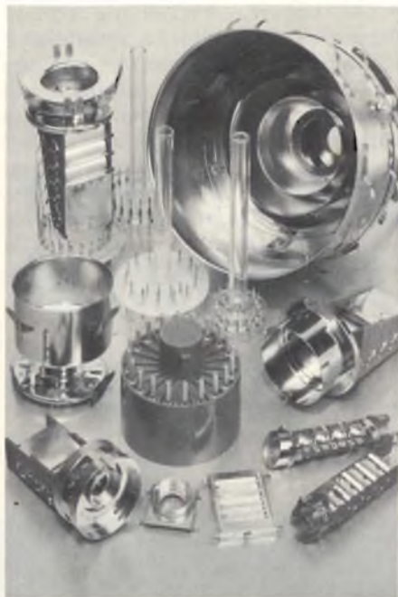
Componenti caratteristici di un attuale fotomoltiplicatore. Le parti "vitali" sono il fotocatodo e il materiale di cui sono ricoperti i dinodi.
