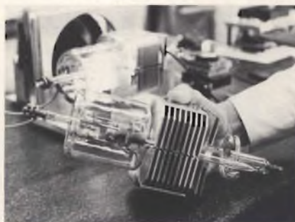
Tubo laser idoneo per fotocopiatrici e apparecchi elettromedicali e stampanti a laser.
