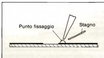
Fig. 7 - Una goccia di stagno depositata nel punto giusto aiuta a posizionare correttamente il chip. Prima però occorre ripulire la zona del rame di tutti i residui della precedente dissaldatura.
