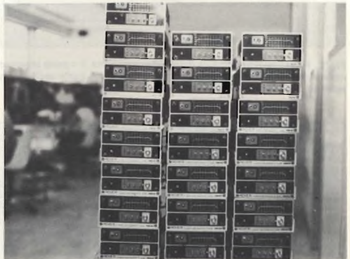
Collaudo CNG 90: generatori vengono tenuti accesi 48 ore prima di procedere alla taratura (piattezza nella banda e valore del livello d'uscita).
