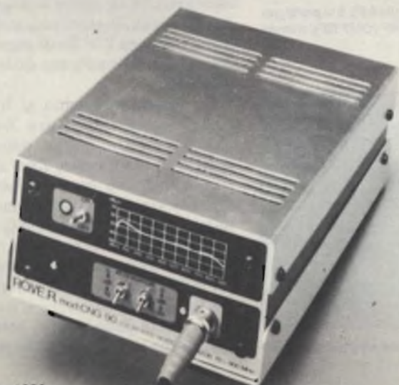
Collaudo CNG 90: generatori vengono tenuti accesi 48 ore prima di procedere alla taratura (piattezza nella banda e valore del livello d'uscita).
