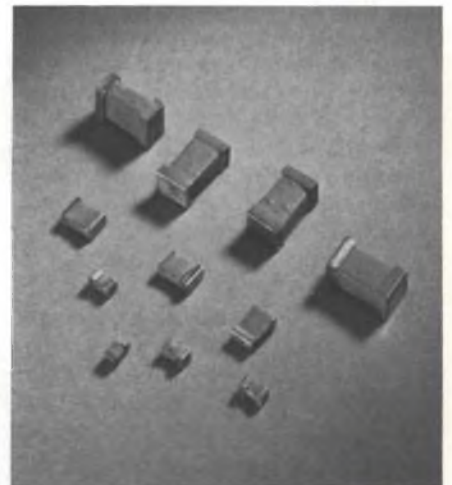
Condensatori chip al tantalio. Il prodotto capacità x tensione x volume occupato è 0,6\text{ }\mu\text{F}/\text{V}/\text{mm}^2 . I valori di capacità vanno da 0,1\text{ }\mu\text{F} a 300\text{ }\mu\text{F} .
