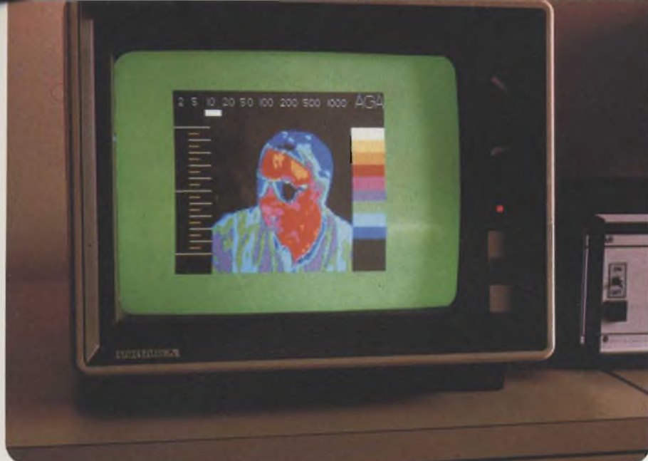
Monitor a colori Hantarex ad elevata definizione impiegato per la presentazione di immagini riprese dalla telecamera a raggi infrarossi AGA.
