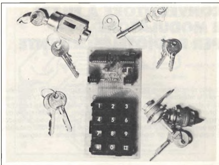
Fig. 3. Per l'apertura della serratura a codice potranno essere collegati a piacere un commutatore rotativo oppure una tastiera: il commutatore rotativo necessita anche di un pulsante supplementare T.
