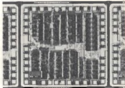
Generatore di punti d'immagine per 80 MHz, in grado di eliminare il tremolio delle immagini nei cinescopi (CRT) ad elevata risoluzione.
