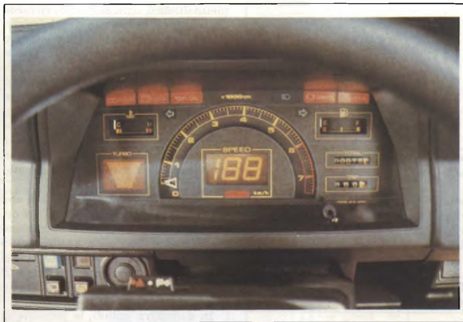
Cruscotto per auto nel quale i parametri di guida e di funzionamento vengono visualizzati mediante display LCD.
