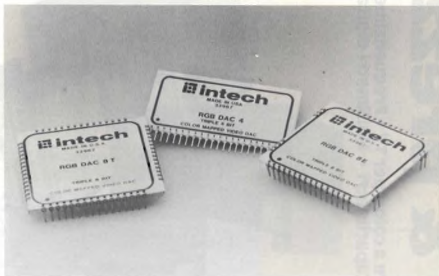
Video DAC particolarmente indicati per l'impiego su tubi a raggi catodici completi di look-up table.
