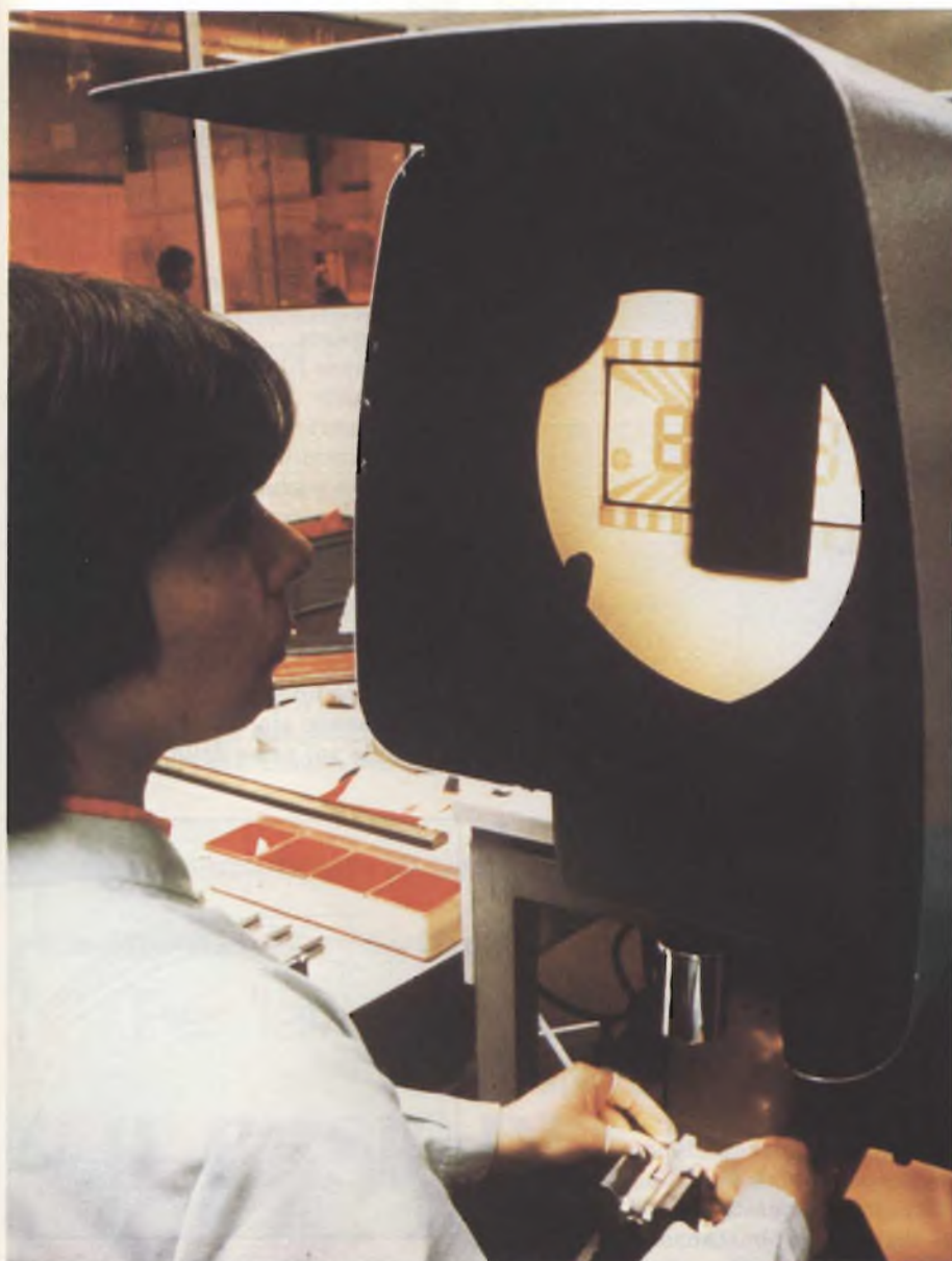
Controllo del master che serviranno alla formazione degli elettrodi anteriori del display LCD. Sugli elettrodi anteriori si trovano le parti attive (luminose o scure) configurate o in segmenti o in punti che serviranno alla formazione dei caratteri alfanumerici.
