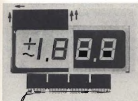
Fig. 6 - Se i filtri polarizzatori hanno i rispettivi piani di polarizzazione a 90° fra di loro, quando la cella nematica viene attivata la luce non passa, e di conseguenza, l'immagine formata sull'elettrodo del display LCD apparirà nera su fondo bianco (immagine a sinistra). Qualora i filtri polarizzatori avessero i loro piani disposti nella stessa direzione (e cioè paralleli), quando la cella nematica viene attivata, la luce passerebbe per cui l'immagine formata sull'elettrodo del display LCD risulterebbe luminosa su campo nero (immagine a destra). Questi display LCD sono di tipo trasmissivo e richiedono quindi sempre una sorgente artificiale di luce disposta posteriormente.
