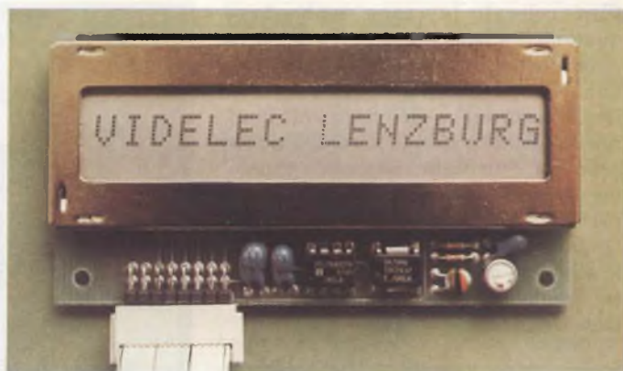
Fig. 8 - Modulo Videlec LC 943160 nel quale i caratteri alfanumerici (16) sono formati mediante matrici di punti (9 x 5).
