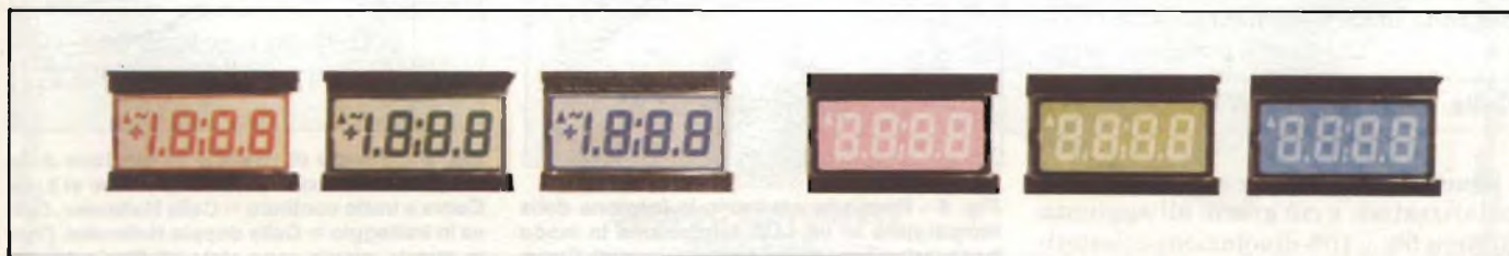
Fig. 2 - Differenti sistemi di presentazione di display colorati. A sinistra: colori ottenuti con polarizzatori selettivi. A destra: colori ottenuti con celle "Guest-Host (tipo White/Taylor).
