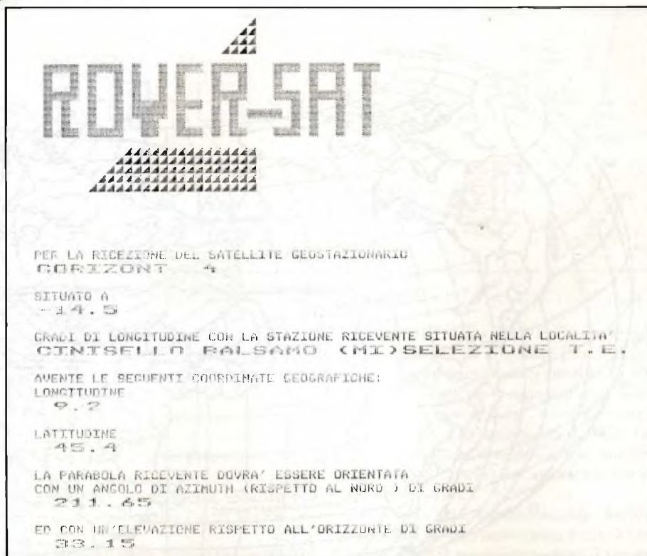
Fig. 10a - Fotocopia programma stampato per la determinazione dei valori azimutali ed elevazione della parabola ricevente.
