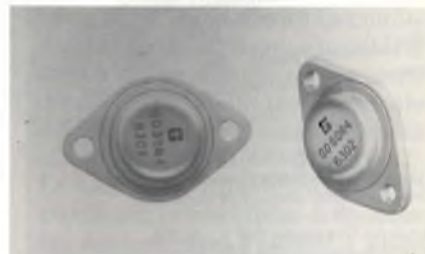
Raddrizzatori al germanio in TO-3 in grado di offrire alta efficienza e basse perdite di potenza.
