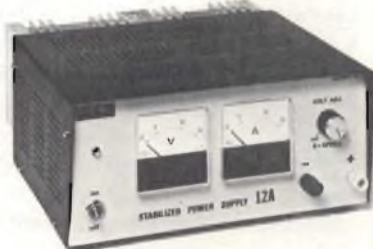
Alimentatore stabilizzato "G.B.C." Con strumenti di misura e protezione elettronica contro il cortocircuito Tensione d'ingresso: 220 V - 50 Hz Tensione d'uscita regolabile: 6 ÷ 14 V.c.c. Corrente max d'uscita: 12 A NT/0530-00
