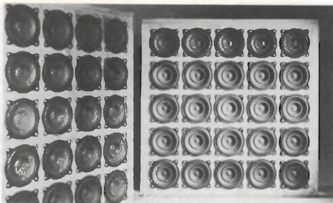
Fig. 6 - Realizzazione pratica di due strutture a 25 altoparlanti ciascuna formata da 5 pannelli di Bessel a 5 altoparlanti. I 5 pannelli di ciascuna struttura sono collegati come indicato in figura 5b.
