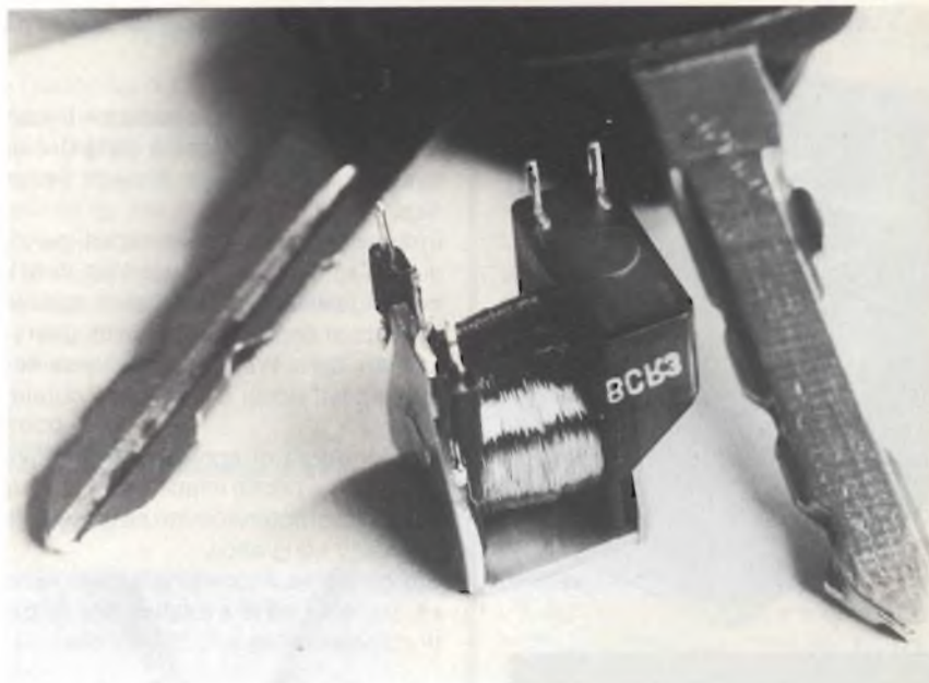
Relé di commutazione K in esecuzione miniaturizzata per adeguarsi all'attuale tendenza di ridurre le dimensioni dei componenti elettronici impiegati nelle auto. Il volume del nuovo relé è ridotto di circa il 60% rispetto a quello del "fratello maggiore", già largamente impiegato nel settore automobilistico.
