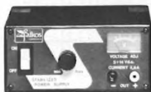
Alimentatore stabilizzato "FALKOS" Con protezione elettronica. Tensione d'ingresso: 220 V - 50 Hz Tensione d'uscita regolab.: 3 ÷ 14 Vc.c. Corrente d'uscita: 2,5 A Dimensioni: 160x75x115 NT/0060-00
