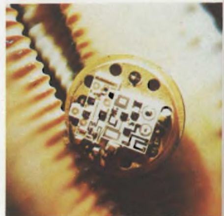
Modulo per microonde in contenitore TO-8.
