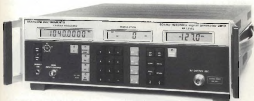
Generatore di segnali 10 kHz ÷ 1040 MHz della Marconi Instruments.
