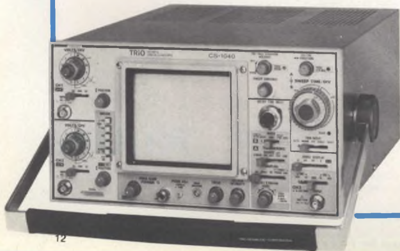
Oscilloscopio CS-1040, a 3 canali e a 6 tracce, con larghezza di banda di 40 MHz e sensibilità di 1 mV/div.
