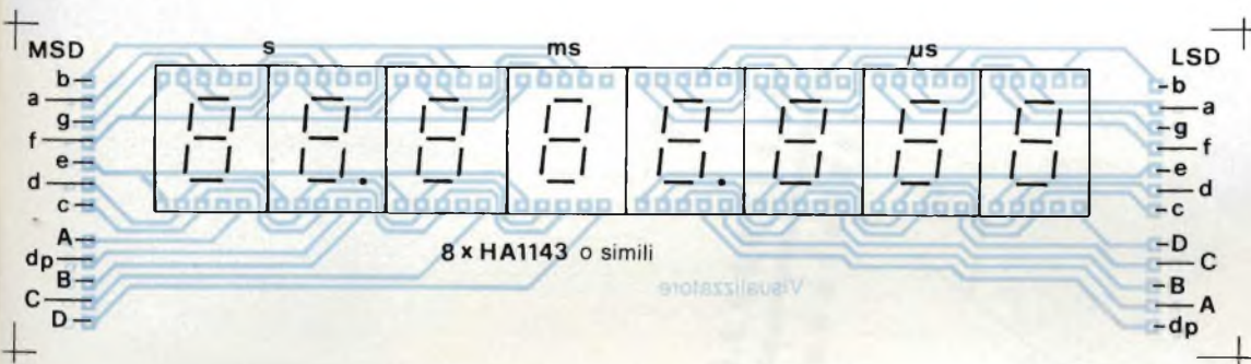
Fig. 6. Disposizione dei componenti sul circuito stampato del display: il collegamento con la basetta principale avverrà mediante piattina multipolare.
