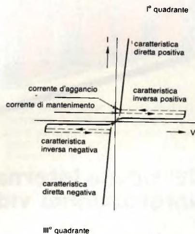
Fig. 6 - Curve caratteristiche del triac. Il triac lavora esclusivamente nel I° e nel III° quadrante. In entrambi i quadranti, fino alla tensione di breakover, il triac si comporta come un diodo polarizzato in senso inverso (caratteristica inversa, positiva o negativa). Superata la tensione di breakover, il triac conduce fortemente in entrambi i quadranti (caratteristica diretta, positiva o negativa).
