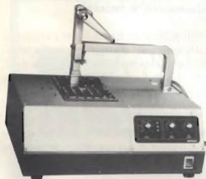
Dissaldatrice da banco in grado di saldare o dissaldare il componente con una sola e semplice operazione.
