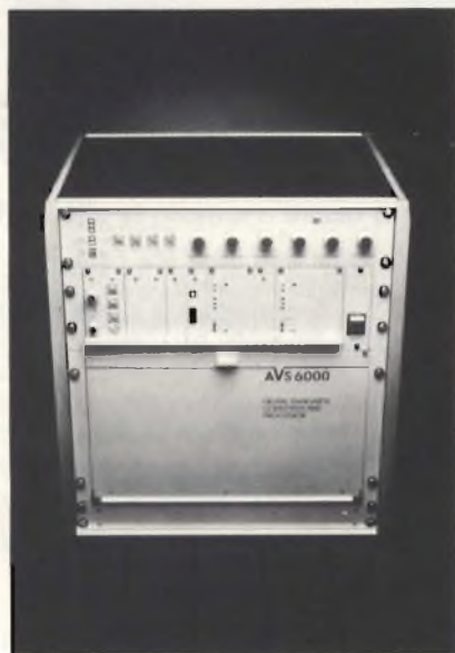
Convertitore e processore digitale di standard tra sistemi NTSC e PAL
