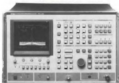
Analizzatore di spettro programmabile ad alta tecnologia denominato MS 611A.
