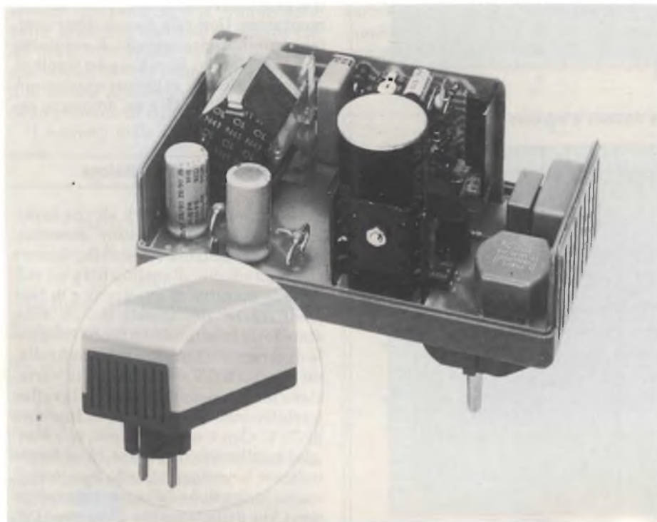
Fig. 1 - Prototipo di alimentatore stabilizzato da inserire nella presa della tensione della rete. Pesa 400 g. Accetta tensioni di rete che possono andare da 90 a 270 V. La potenza di uscita s'aggira sui 30 W.
