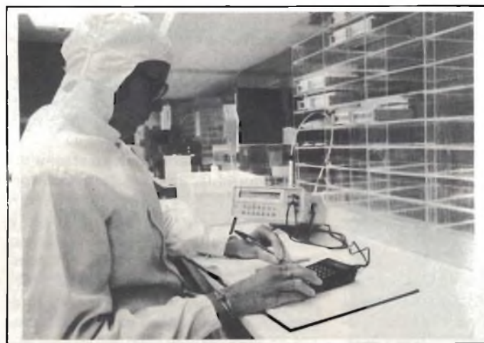
Impiego del multimetro HP 3468A per il controllo dei parametri di circuiti integrati.
