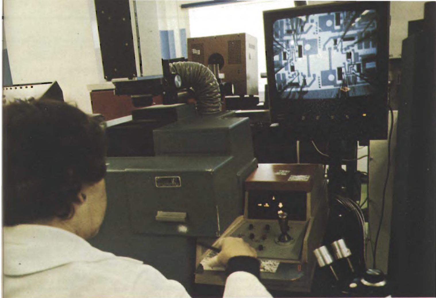
Controllo delle strutture circuitali di un circuito a film spesso, al centro di produzione della RIFA a Stoccolma. La RIFA è rappresentata in Italia dalla RACOEL s.a.s. C.so di Porta Romana, 121 - 20122 Milano - Tel. 5452608 - 598426.
