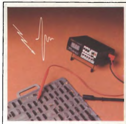
Fig. 13 - Il multimetro 467 possiede un sistema di protezione a varistore che permette di sopportare picchi transitori di 6 kV per 100 μs su tutte le portate di tensione e di resistenza.
