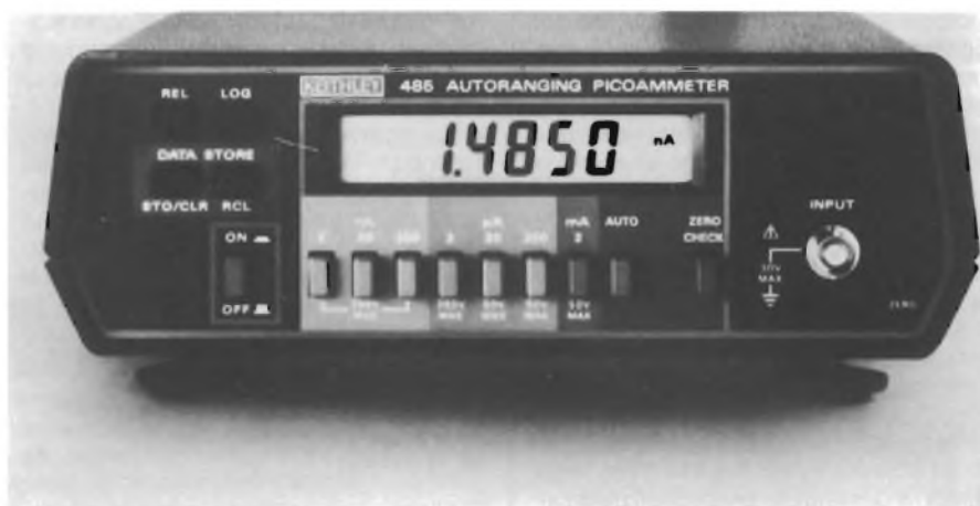
Picoamperometro digitale ad autocommutazione di scala (sensibilità 0,1 pA), interfacciabile opzionalmente in IEEE-488 per personal computers.
