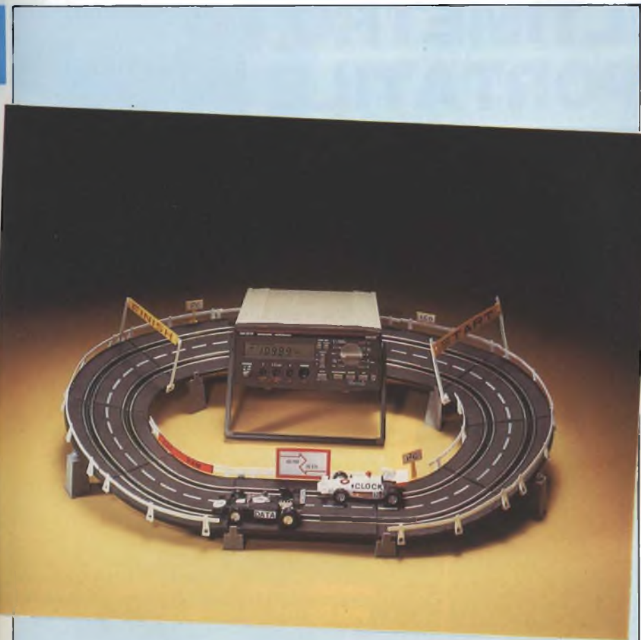
Fig. 1 - Questa analogia di modellini di macchine che transitano su due differenti rotale può dare un'idea del significato fisico del bus I 2 C Philips-Intel. In questo bus, i dati e le temporizzazioni (clock) transitano in modo seriale. Gli interscambi tra convertitore analogico/digitale, display LCD, e RAM avvengono nel multimetro Philips PM 2519 proprio attraverso il bus seriale I 2 C.
