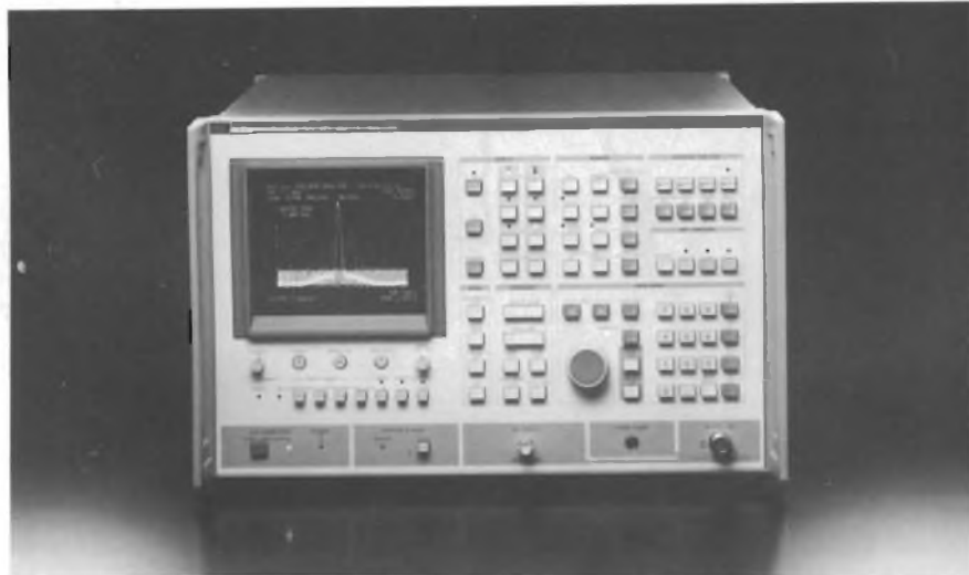
Analizzatore di spettro ad alta tecnologia, particolarmente adatto a sistemi automatici di misura.
