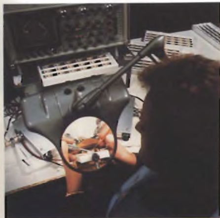
Fig. 9 - Inserimento dei trasformatori r.f. (d'accoppiamento e di adattamento di impedenza) nei circuiti del modulo.
