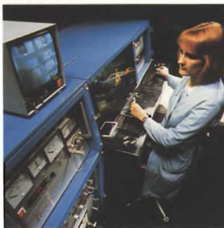
Fig. 6 - Calibratura del valore ohmico dei resistori di nicromo mediante raggio laser. Questo sistema permette di ottenere valori di resistenza con tolleranze fino all'1%.
