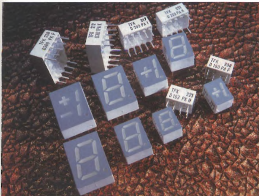
Display in tecnologie GaP e GaAsP; altezza della cifra mm 7, 10, 13; da 1 digit, 1/2 digit con simboli \pm 1 .
