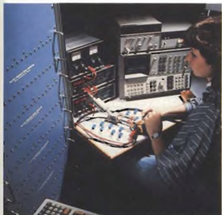
Fig. 11 - Verifica dei più importanti parametri elettrici dei moduli già muniti di cappuccio. Vengono controllati: battimento semplice di seconda armonica, composto di terza armonica e modulazione incrociata. Il sistema di controllo è computerizzato. Può verificare il funzionamento dei moduli alle frequenze di lavoro di oltre 94 canali TV fino alla frequenza di 600 MHz.
