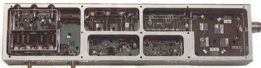
Vista interna del tuner del ricevitore SR-800.
