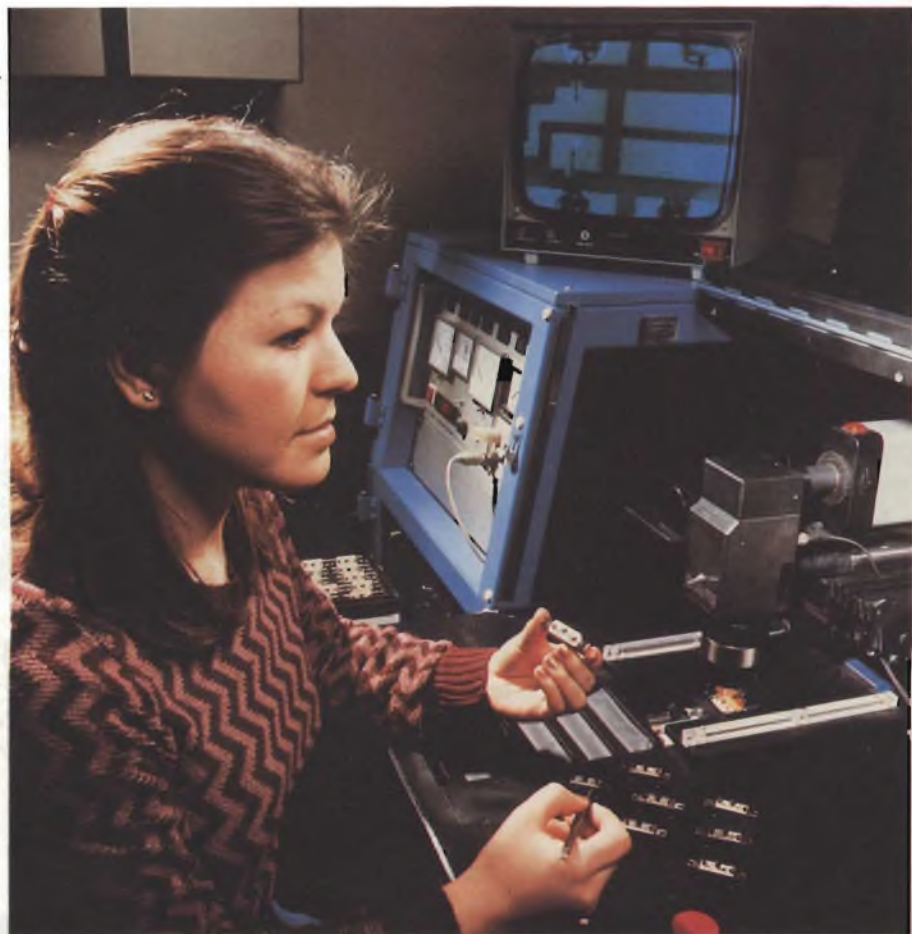
Fig. 8 - Effettuazione dell'operazione di bonding eutettico tra chip e substrato di allumina. Questa operazione è facilitata e resa possibile da un sistema originale di concentrazione localizzato del calore richiesto dal bonding.
