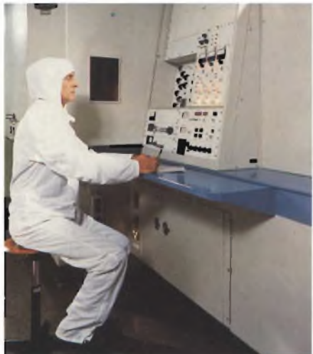
Fig. 4 - Il sistema di drogaggio mediante inserimento (o impianto) di ioni negli strati attivi che formano le giunzioni collettore/base e base/emettitore permette di ottenere giunzioni molto sottili, attraversabili quindi in tempi brevissimi da parte dei portatori di cariche. Questo permette di ottenere frequenze di taglio di valore molto elevato. L'apparecchiatura per l'impianto degli ioni presentata in questa figura è una delle più potenti e più avanzate attualmente esistenti.
