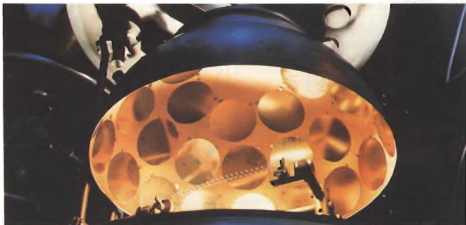
Fig. 7 - L'adesione perfetta a caldo (bonding eutettico) tra superficie del chip e substrato di allumina è resa possibile solo rivestendo mediante oro la superficie del chip a contatto con il substrato.
