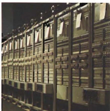
d) apparecchiature per la valutazione della durata di vita di un microinterruttore reed.
