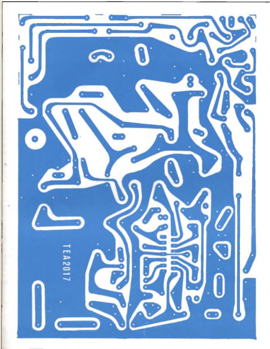
Fig. 9 - Circuito stampato del monitor visto dalla parte del rame.
