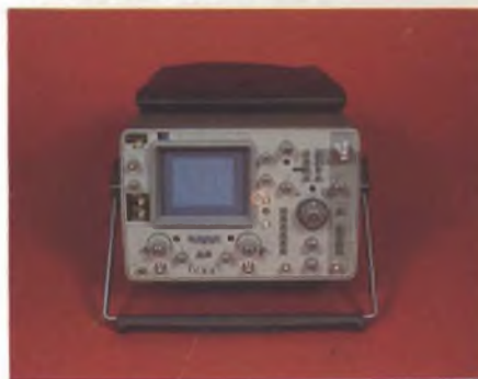
Oscilloscopio a memoria analogica Hewlett-Packard 1744A, a persistenza variabile. Larghezza di banda: 100 MHz. Tempo di salita: <math>< 3,5 \text{ ns}</math>. Velocità di scrittura 1800 cm/ \mu\text{s} . Velocità di scansione 5 ns/div (espansione x 10). Sensibilità 1:2 mV fino a 30 MHz; 5 mV fino a 100 MHz.
