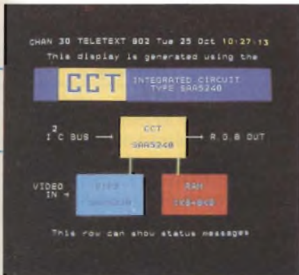
b) schema a blocchi dell'EURO-CCT
