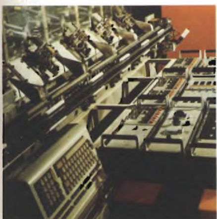
c) selezione dei microinterruttori reed in base alla loro sensibilità;
