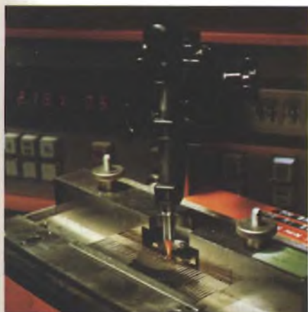
a) sistema di rilevamento dello spessore del materiale di cui sono fatti i contatti;
