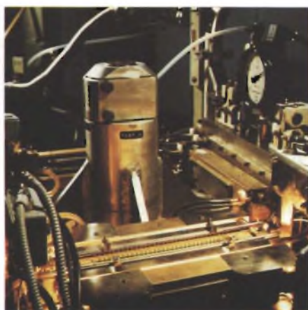
b) incapsulamento dei contatti reed nella fiala di vetro, ermeticamente sigillata dopo essere stata riempita con azoto;
