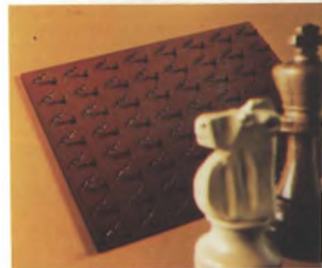
Gioco degli scacchi computerizzato. Per segnalare le posizioni dei pezzi vengono utilizzati microinterruttori reed (per cortesia della Hegener & Glaser GmbH).
