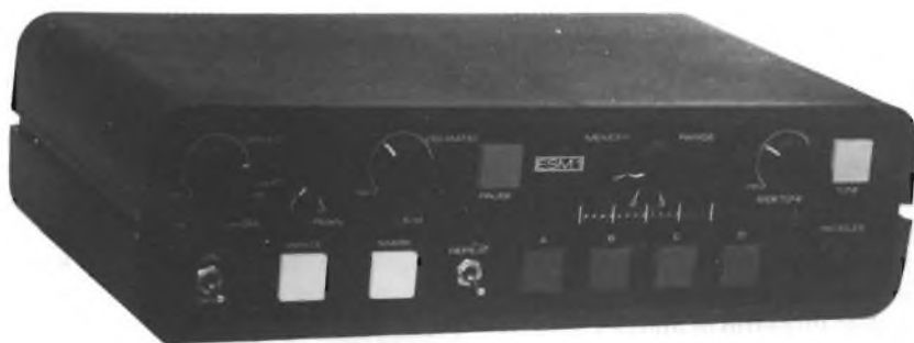
Fig. 4 - Prototipo del tasto Morse elettronico. Il pannello frontale è stato successivamente modificato, allo scopo di facilitare la costruzione meccanica.
