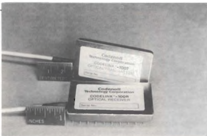
Fig. 1 - Codelink™ 100. Unità di trasmissione/ricezione su cavo in fibra ottica. La luce viene inviata sul cavo ottico da un laser e viene ricevuta all'altra estremità del cavo da un fotodiode PIN.
