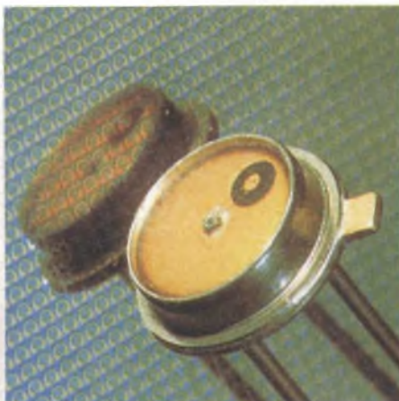
LED emettitore SFH 407 prodotto dalla Siemens. Sullo sfondo è visibile il wafer dal quale è stato tratto il chip del LED.
