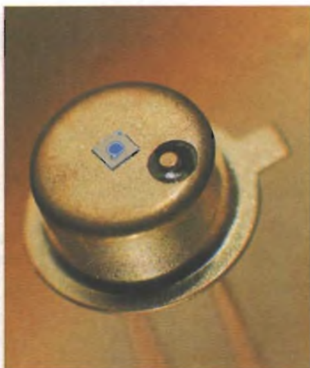
Fig. 8 - Struttura geometrica di un fotodiode PIN al silicio. Lo strato intermedio i ha uno spessore molto grande rispetto ai due strati esterni. Fotodiode PIN SHF202.
