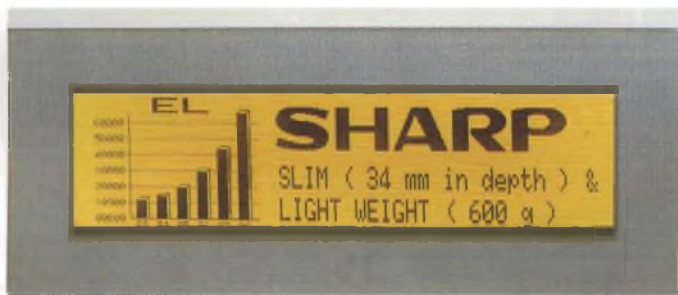
Fig. 7 - Esempio di testi riprodotti dal pannello elettroluminescente LJ640U01. Questo pannello possiede un'area attiva di 60 mm x 192 mm. Il numero di pixel è 640 x 200. È particolarmente adatto alla riproduzione di testi all'numerici.
