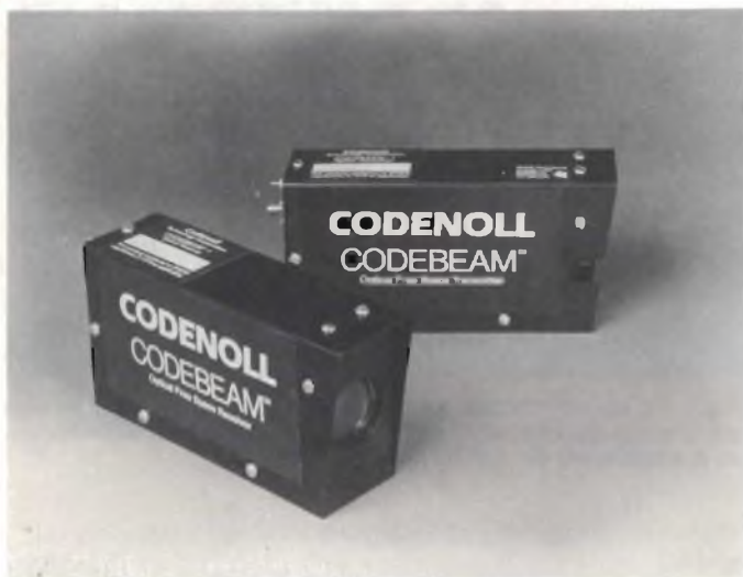
Fig. 4 - Codebeam™ 20. Sistema di trasmissione di informazioni a vista che utilizza luce-laser per trasmettere segnali. Tra trasmettitore e ricevitore non è quindi richiesto alcun cavo. Ha incorporato un sistema di allineamento automatico del raggio di luce.
