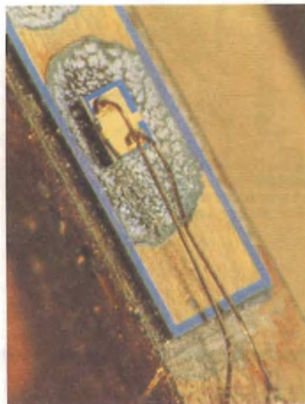
Fig. 5 - Struttura geometrica di un diodo laser a striscia di tipo Al-Ga-As. In basso, il profilo dell'indice di rifrazione immaginario laterale. Laser a striscia Ga-Al-As, depositato su substrato di silicio e fissato su un radiatore di metallo; lavora sulla prima finestra di trasmissione ( 800 \div 900 \text{ nm} ).
