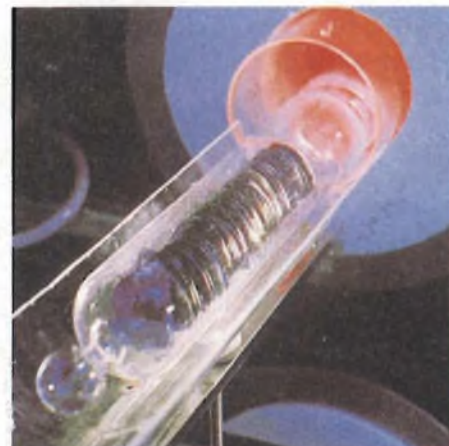
Una fase di lavorazione dei diodi emettitori LED. Qui, dentro all'ampolla sigillata di quarzo, vengono sistemati i wafer di gallio/arsenico per essere sottoposti al processo di diffusione.
