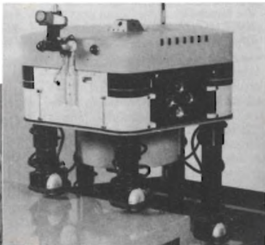
Fig. 2 - Il robot mobile della Hitachi vede tutto quello che lo circonda e lo memorizza; indi confronta ogni situazione particolare con una analogia precedentemente memorizzata, dopodiché prende decisione per scansare gli ostacoli sopraggiunti lungo il suo cammino.
