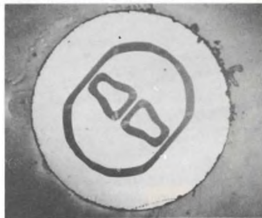
Fig. 4 - Come si presenta in pratica il chip (membrana di silicio + piezoresistori) visto dai suoi due lati.
