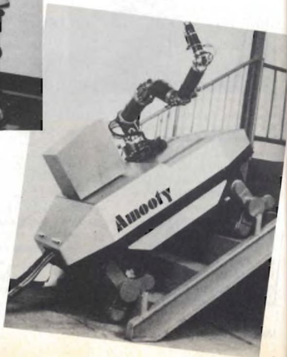
Fig. 2 - Il robot mobile della Hitachi vede tutto quello che lo circonda e lo memorizza; indi confronta ogni situazione particolare con una analogia precedentemente memorizzata, dopodiché prende decisione per scansare gli ostacoli sopraggiunti lungo il suo cammino.
