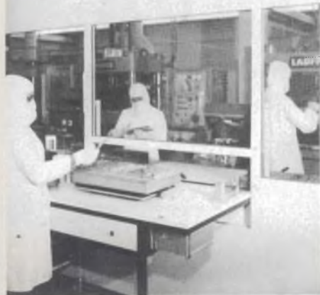
Il locale dove si trovano le presse meccaniche per i contenitori in plastica è separato da una vetrata dagli altri locali.
