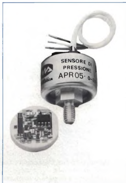
Sensore di pressione a film spesso, prodotto dalla MARELLI AUTRONICA. Il suo principio di funzionamento è basato sulle proprietà piezoresistive di resistori realizzati in film spesso e collegati in un ponte di Wheatstone serigrafato su un diaframma di allumina ( Al_2O_3 ), solidamente applicato su un supporto rigido dello stesso materiale. In film spesso è realizzato anche l'amplificatore del segnale di uscita del ponte; l'amplificatore è compreso nello stesso involucro.
