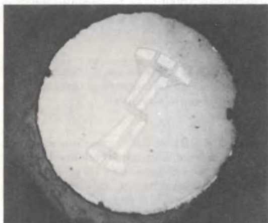
Fig. 4 - Come si presenta in pratica il chip (membrana di silicio + piezoresistori) visto dai suoi due lati.
