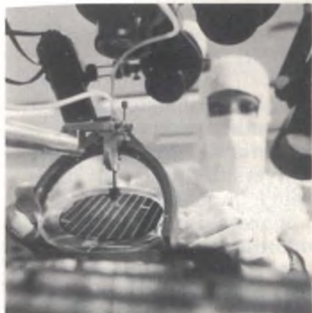
Le caratteristiche elettriche dei singoli chip vengono controllate quando ancora essi si trovano a livello di wafer.
