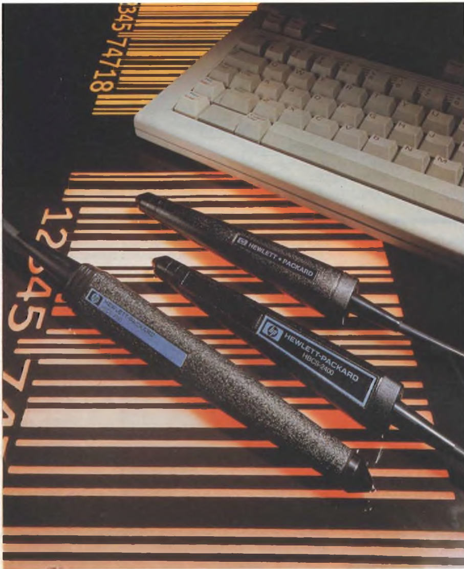
Fig. 1 - Codici a barre, lettore e decodificatore del segnale d'uscita del lettore. (Foto, Hewlett-Packard).
