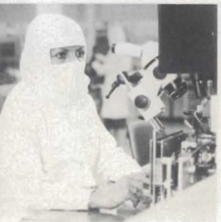
Un'operatrice controlla al microscopio i contatti dei terminali del contenitore.
