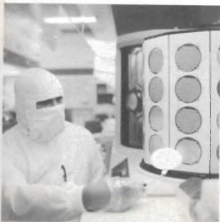
I wafer di silicio vengono sistemati su particolari contenitori, indi inoltrati nei forni di diffusione dentro ai quali avverrà la deposizione degli strati dei vari materiali, per esempio, il nitruro di silicio.
