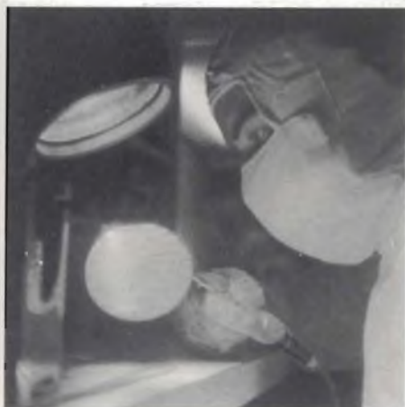
Wafer fortemente illuminato. In queste condizioni, è già possibile riscontrare, a occhio nudo, eventuali impurezze depositate sul wafer di silicio.
