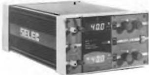
Media potenza - caratteristiche di stabilità elevatissime - controllo visivo di tutte e sue funzioni - tracking automatico - programmabilità remota fino a 1500 Hz - personalissimo e gradevole design - queste ed altre caratteristiche fanno dei modelli MDS i più compatti alimentatori stabilizzati oggi in commercio.
