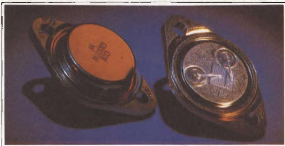
**Transistori bipolari di potenza MOTOROLA.** Sono darlington di potenza che sopportano una corrente continuativa di 40 A ed una tensione di 400 V.
