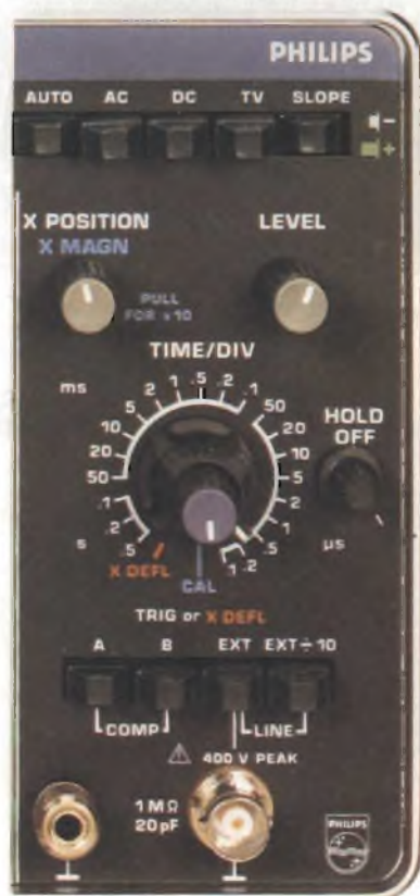
Fig. 12 - Particolare del pannello con base dei tempi doppia (principale e ritardata) dell'oscilloscopio PHILIPS PM 3217B.
