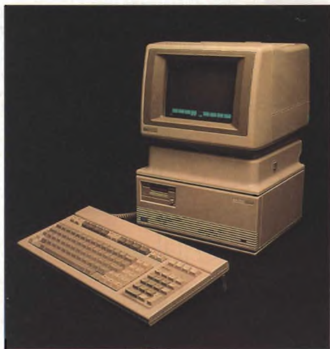
HP 150: il personal computer con il touch-screen. Basta un dito per impartire comandi, spostare il cursore, trasferire testi o dati il tutto più rapidamente e con risultati più sicuri.
