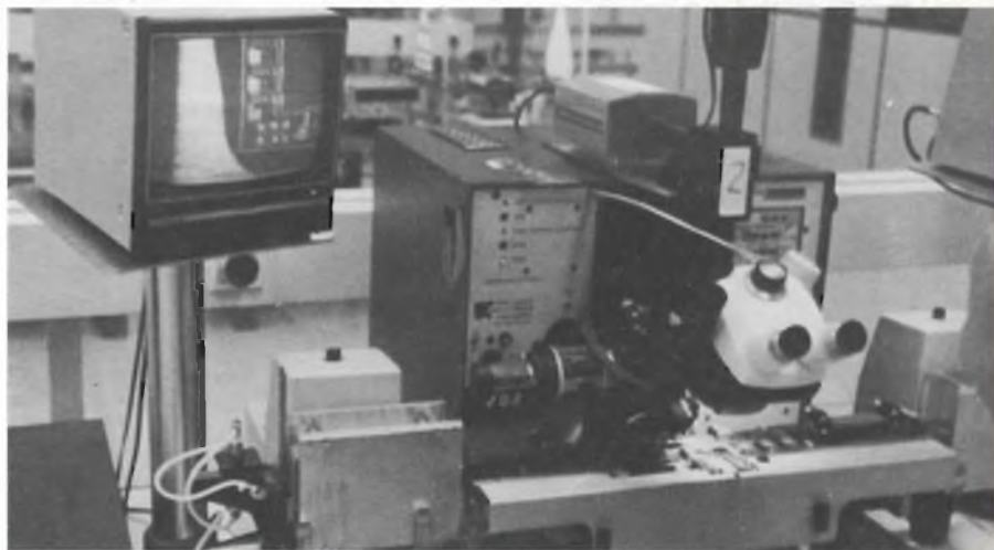
Microscopio elettronico a scansione per il controllo dei chip difettosi.
