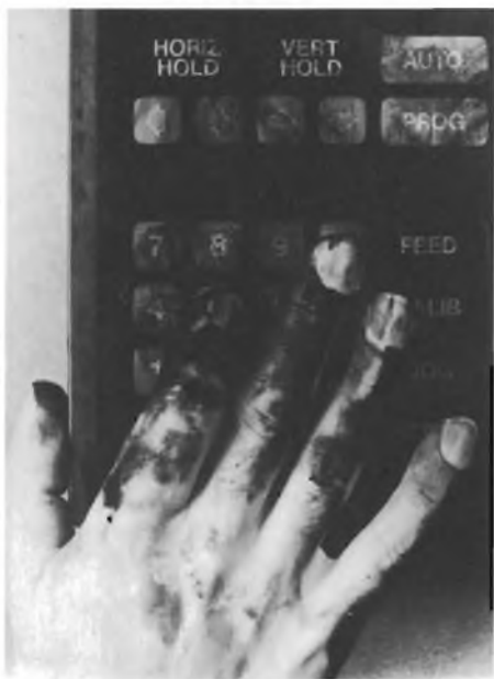
Fig. 4 - La possibilità di impiego in ambienti severi fa della tastiera a membrana TC l'interfaccia ideale uomo-macchina nelle applicazioni industriali. Non ci sono parti in movimento esposte allo sporco ed essendo a superficie liscia può essere pulita rapidamente e facilmente mantenendo inalterato l'aspetto esterno.
