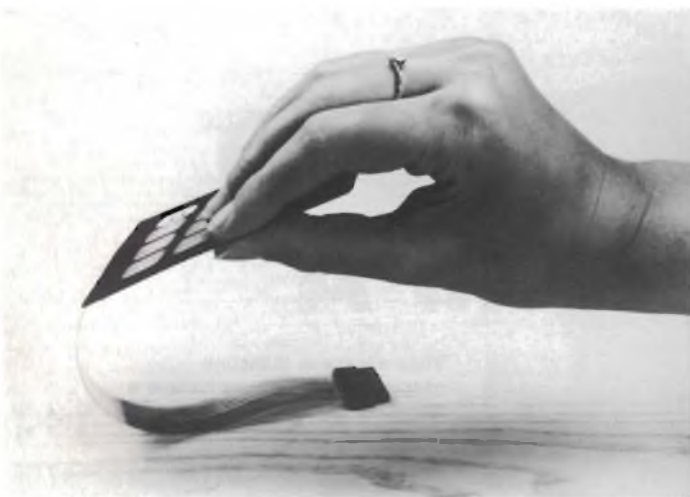
Fig. 3 - Basso profilo e feedback tattile sono le caratteristiche salienti delle tastiere TC.
