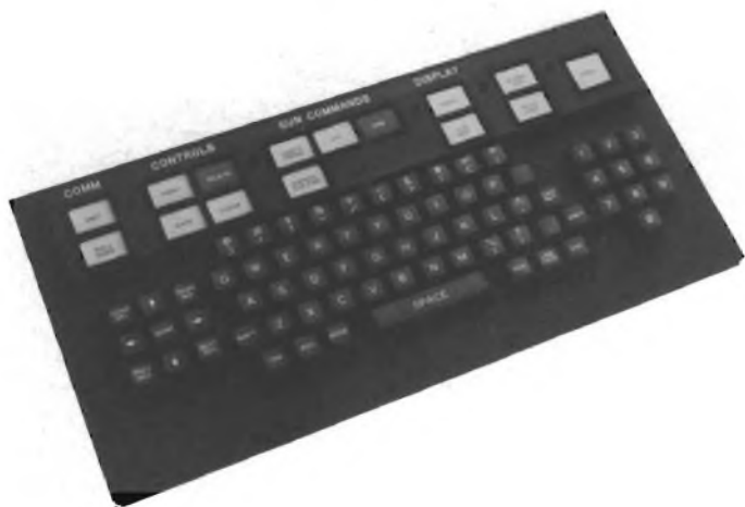
Tastiera per impieghi militari prodotta dalla Industrial Electronic Engineers (rappresentata in Italia dalla Brelco s.r.l.). Associa la tecnologia "full-travel", e cioè corsa completa del tasto, con la "snap action", e cioè con scatto di ritorno veloce; la combinazione di queste due funzioni permette un veloce ingresso dei dati.
