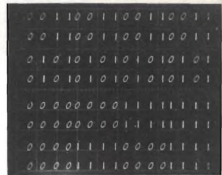
Fig. 2 - Come compaiono gli "uni" e gli "zeri" sullo schermo dell'oscilloscopio.
