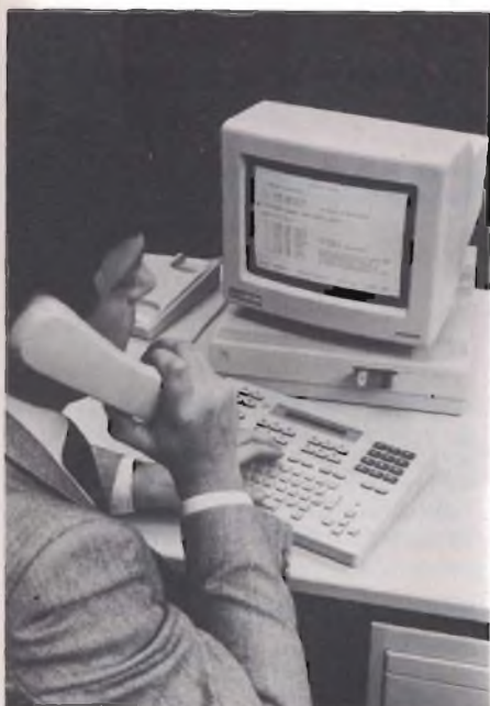
Fig. 3 - Sistema di commutazione Siemens HICOM per la trasmissione mixed-mode di parlato, immagini e dati. È costituito da un monitor, una tastiera e da un telefono. È il primo sistema che riunisce in una unica unità, le funzioni di un telefono digitale con quelle di un terminale per la trasmissione ricezione di testi e dati. Un lettore di "card" consente inoltre l'accesso ad informazioni personali centralizzate e a servizi appartenenti ad altri terminali.
