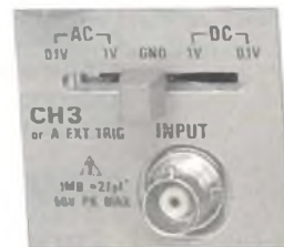
Fig. M - Particolare del pannello che mostra il connettore usato per il canale 3 oppure per un segnale di trigger esterno.
