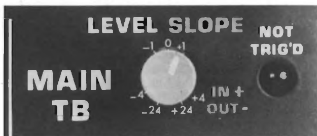
Fig. 8 - Particolare del pannello frontale che evidenzia l'andamento non lineare del livello di trigger in particolari tipi di oscilloscopi.
