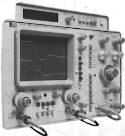
Fig. 3 - Oscilloscopio modello 1726A, della Hewlett Packard, dotato della base dei tempi a doppio ritardo per la misura diretta di intervalli di tempo. La lettura è visualizzata sul display digitale, visibile sopra lo schermo e sporgente dalla parte superiore dello strumento.
