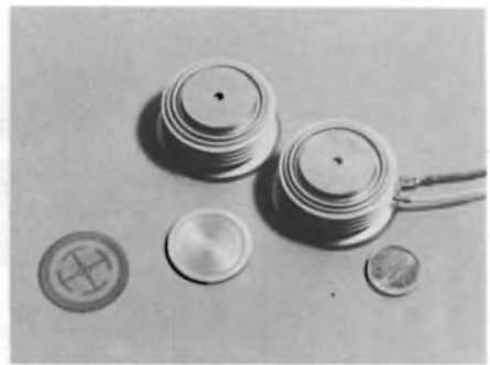
Tiristori di potenza THOMSON, in esecuzione a disco e relativo pellet.
