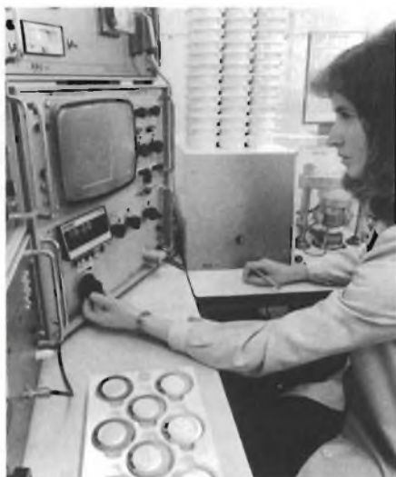
Controllo sullo schermo di un monitor del valore della tensione di bloccaggio di un tiristore veloce, presso i laboratori R & D della BROWN BOVERI.
