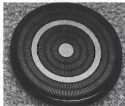
Fig. 3 - È il pellet di un tiristore GTO della MARCONI; misura 5 cm di diametro. Si noti la struttura interdigitata gate/catodo.
