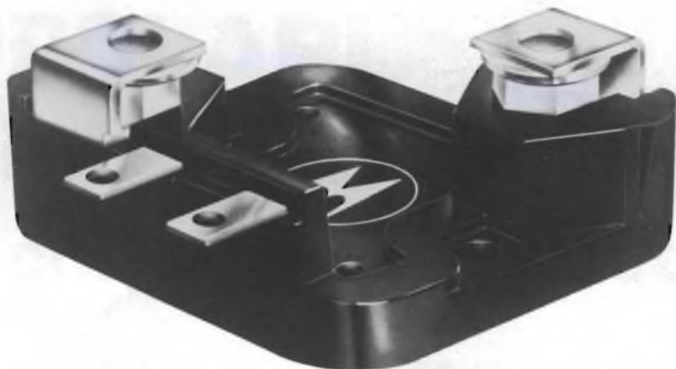
MJ10101: transistore Motorola per alte correnti in contenitore "case 346-01" per una potenza dissipabile di 500 W. (Archivio MOTOROLA).
