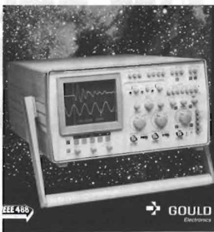
Foto C - Oscilloscopio a memoria digitale Gould 4035 da 20 MHz, a due canali; 2 mV/div., sensibilità verticale. 1 Kbyte di memoria per canale.
