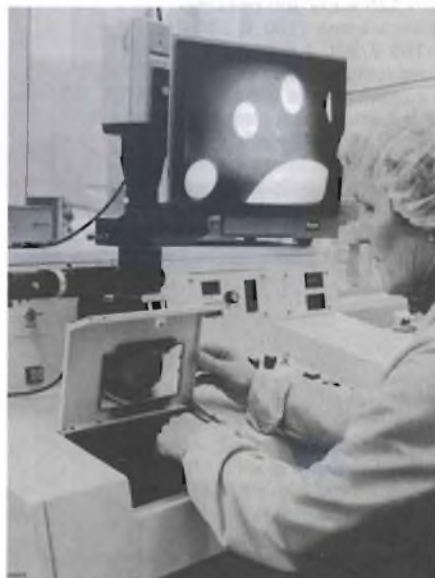
Operazione di mascheratura dei chip dei tiristori GTO (Foto, BROWN BOVERI).
