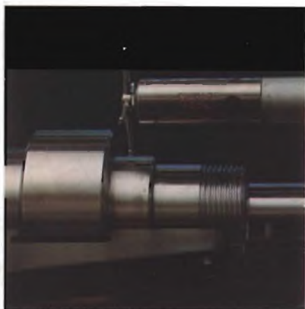
Controllo di un albero sul robot di misura.
