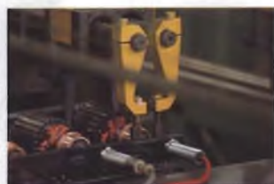
Equilibratura per asportazione di materiale.
