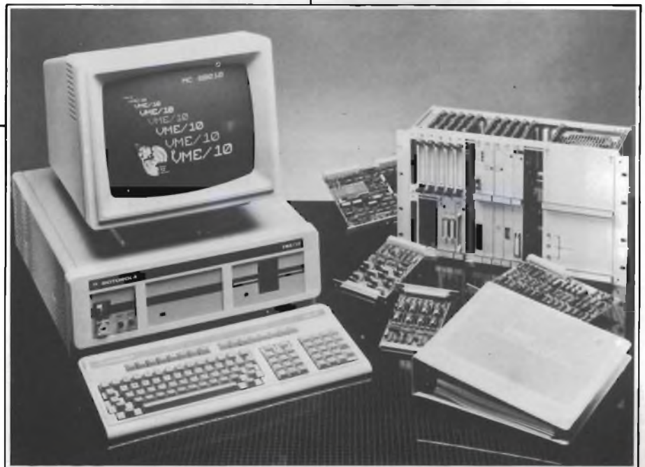
Fig. 1 - Il VME/10, un sistema versatile che può essere usato sia come stazione di sviluppo sia come sistema OEM. Si tratta di una tipica stazione singola.
