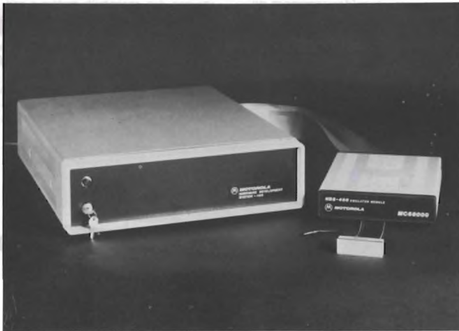
Fig. 3 - Per lo sviluppo dell'hardware è indispensabile un emulatore. L'emulatore in tempo reale HDS400 può essere collegato al VME/10 o all'EXORmacs, ma anche a un VAX.
