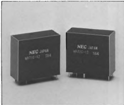
MR 71: Relè verticale per circuito stampato - 1 lavoro, 1 riposo, 1 scambio - portata dei contatti: 10 A, 125 Vcc, 380 Vca - in esecuzione flux - free o sigillata - approvati UL - CSA
