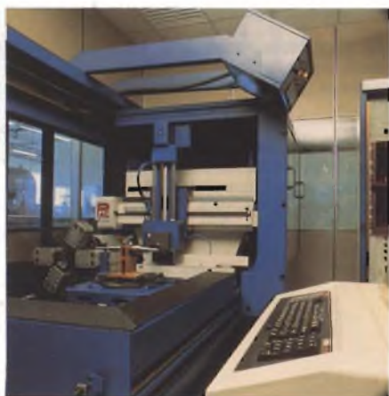
Robot di misura per il collaudo tridimensionale automatico dei componenti.
