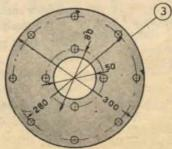
riesce a vedere dalla figura (n. 2). Il disco (n. 3), e gli anelli (n. 4 e 5) sono tutti in compensato, ed hanno anche lo stesso diametro esterno di mm. 300; il diametro interno si ricava senza nessuna difficoltà dal disegno. Lo spessore di questi particolari è di circa tre millimetri, e dipende naturalmente dal compensato che si ha a disposizione.
