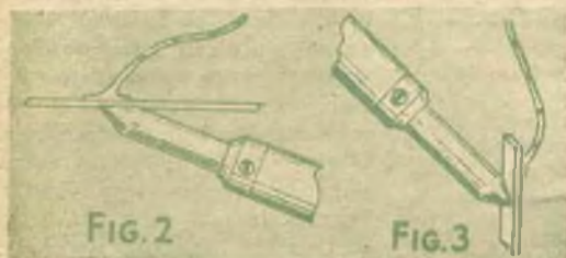
FIG. 2. — Come va effettuata una saldatura orizzontale. FIG. 3. — Come invece su di un piano verticale.
