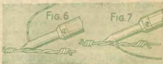
FIG. 6. — Modo errato di sciogliere lo stagno. FIG. 7. — Come lo stagno va sciolto: cioè sul pezzo da staginare e non sul saldatore, come avviene, invece, in fig. 6.
