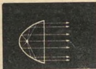
Fig. 1. — Riflettore parabolico con lampada nel fuoco. I raggi escono paralleli illuminando bene solo una piccola superficie.
