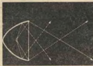
Fig. 2. — Spostando nello stesso riflettore la lampada verso l'esterno si ottiene un fascio di luce molto più ampio e più idoneo ad una buona illuminazione.
