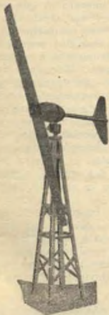
Fig. 1 - Sistemazione dell'aeromotore, con sostegno a traliccio.
