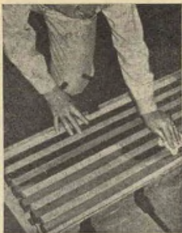
Fig. 2. - Sopra ad una superficie perfettamente piana i vari listelli saranno serrati con un morsetto.
