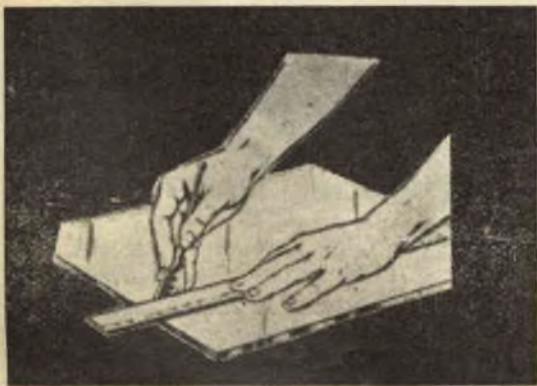
Fig. 1 — Tenendo l'utensile all'incirca come una penna si tratterà l'incisione tirando verso di noi il tagliavetro.
