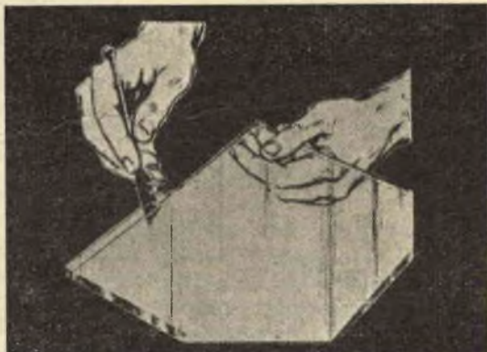
Fig. 2. — Per le linguette da 1 a 5 mm. di larghezza si utilizzeranno le tacche poste a lato dell'utensile.
