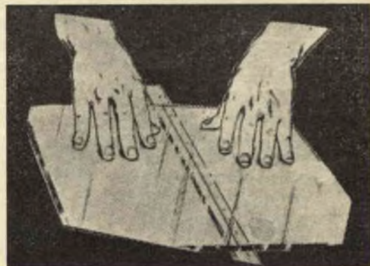
Fig. 4. — Per separare i pezzi grandi si ponga la riga sotto la linea di incisione e si prema su ambo le parti.
