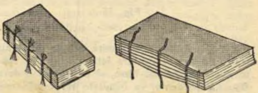
Fig. 10. - Nel libro di sinistra la catenella è stata ben effettuata; in quello di destra invece si è tirato troppo; da questo trae origine la rigonfiatura centrale del dorso.
