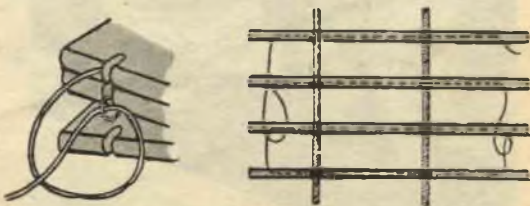
Fig. 9. - Ecco le volute che il filo deve fare praticando la catenella agli estremi del dorso.
