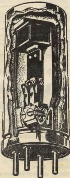
Fig. 1 - Come si presenta il vibratore visto dall'interno
