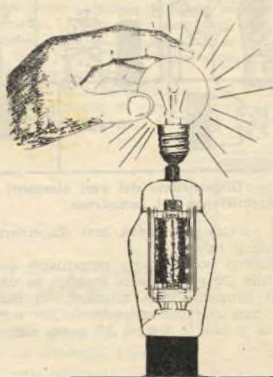
Fig. 10. — Potremo controllare pure se è presente l'Alta Frequenza nel trasmettitore, applicando una lampadina da 5 watt sul cappuccio della valvola 807.
