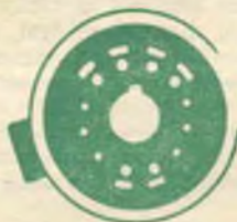
Fig. 5. — Quando il magnete viene posto sotto il tubo, in direzione del nono piedino dello zoccolo, la freccia del magnete va rivolta verso lo schermo del televisore.
