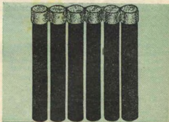
Fig. 6. — Utilizzando carboncini tolti da vecchie pile, è possibile ottenere la piastra di carbone necessaria per l'anodo come visibile in fig. 5.
