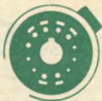
Fig. 4. — Quando il magnete viene collocato in direzione del secondo piedino dello zoccolo, la freccia, posta sul piedino stesso, va rivolta verso lo zoccolo del tubo.
