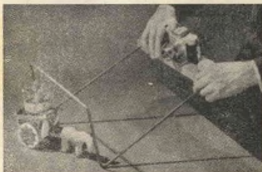
Fig. 4. — Quando non si vogliono commettere errori circa il campo da inquadrare e la distanza focale, si applichi alla macchina fotografica questo piccolo telaio di filo di ferro, preparato su misura per il tipo di lente che si vuole usare.
