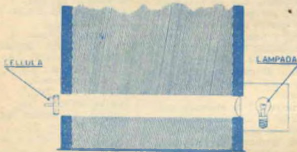
Fig. 4 - Un sistema antifurto, o di sicurezza può essere rappresentato da una lampadina la cui luce concentrata da una lente raggiunge la cellula. Se una persona passando interrompe il fascio di luce, il relay metterà in funzione il sistema di allarme.
