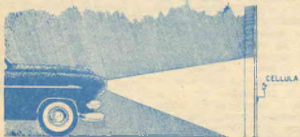
Fig. 5 - Per aprire il garage, si può disporre la cellula fotoelettrica, in modo che il fanale della macchina proietti la luce sulla sua superficie
