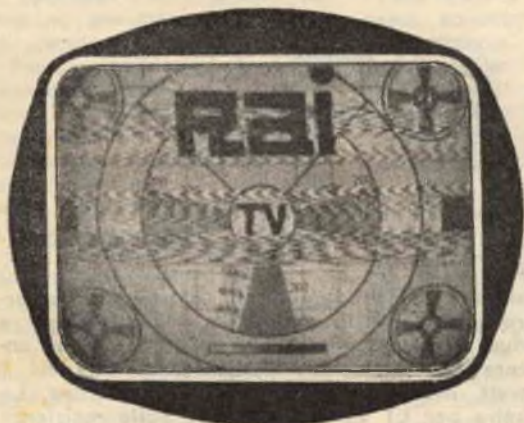
Fig. 1. — Una fascia orizzontale increspata attraversa rapidamente lo schermo. Nessun dubbio sulla natura dell'interferenza: un apparecchio di diatermia è in azione nelle vicinanze.
