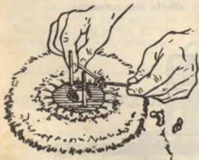
Fig. 4. — Volendo usare lo apparecchio anche per dare la cera è necessario procurarsi una seconda spazzola, di panno, da applicare alla prima; per poter far ciò, è necessario provvederla di un supporto che permetta di fissarla facilmente e rapidamente.
