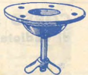
Fig. 3 - Questa flangia dispone di una calotta, la quale permette eventualmente di inclinare in qualunque senso tutto il complesso, rispetto al treppiede.
