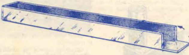
Fig. 4. - La custodia metallica del tubo di vetro si può facilmente ricavare con della lamiera di 1 mm. di spessore, opportunamente piegata.
