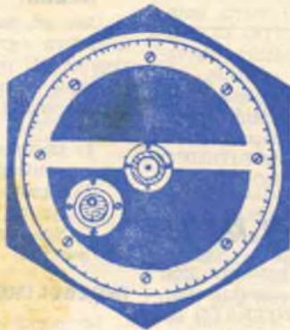
Fig. 2 - Per effettuare misure angolari, ci si servirà di una corona circolare graduata fissata alla piattaforma. Si noti pure la disposizione della livella circolare a bolla d'aria.
