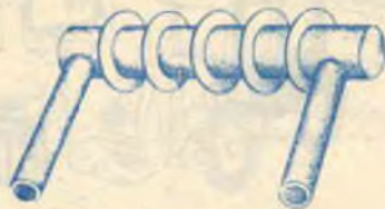
Fig. 3 - Un radiatore rudimentale si può anche costruire saldando su di un tubo metallico delle rondelle di ottone o ferro, distanziate di circa cm. 1,5 l'una dall'altra.
