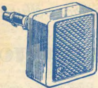
Fig. 2 - Questo è il radiatore da sistemare nell'interno della vettura; esso potrà essere costruito utilizzando elementi di un vecchio radiatore inservibile.
