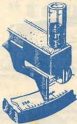
Fig. 9 - Sotto la custodia metallica contenente il tubo di vetro, si saldi un piccolo indice, necessario per le misure angolari.
