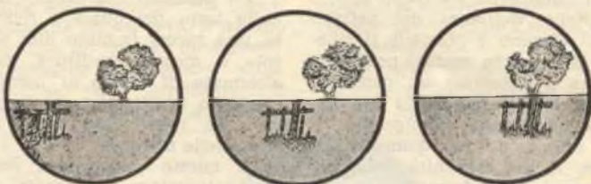
Fig. 6 - Utilizzando invece due mezzi specchi, appariranno due semi-immagini sfasate. La parte inferiore (mezzo specchio) si muoverà incontro all'altra sino al ricongiungimento perfetto.
