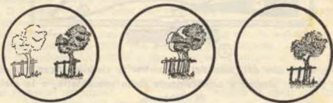
Fig. 5 - Utilizzando un vetrino ed uno specchio le due immagini ben separate andranno, mano a mano, avvicinandosi l'una all'altra sino a sovrapporsi a messa a fuoco perfetta.
