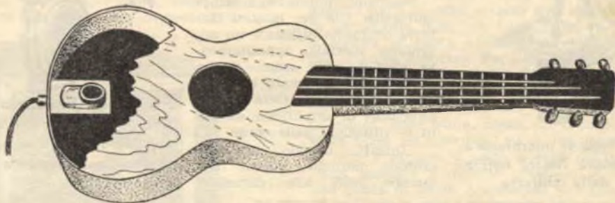
Fig. 5. — Il microfono verrà fissato entro alla chitarra come vedesi in figura.
