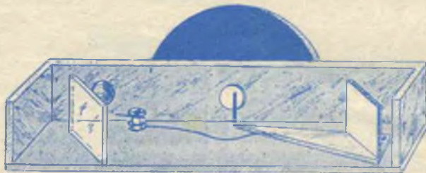
Fig. 1 - Telemetro aperto: nel disegno sono visibili la disposizione dei vari elementi. Notiamo a sinistra il vetrino, ed a destra lo specchio, montato sul sistema d'orientamento.
