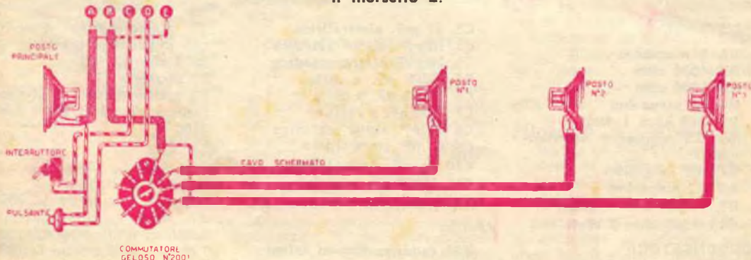
Fig. 4. — Con questo schema si ha la possibilità di collegarsi con ben 11 posti. S'intende che in questo caso solo il posto principale ha la possibilità di chiamare i posti secondari.
