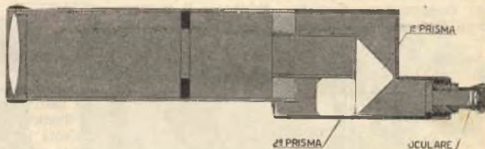
Fig. 3. — Si noti nel telescopio ultimato, la disposizione della parte ottica, e la posizione del diaframma.
