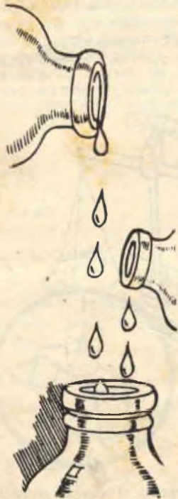
Fig. 1. - Per ottenere l'acqua regia, si mescolino tre parti di acido cloridrico e una di acido nitrico.
