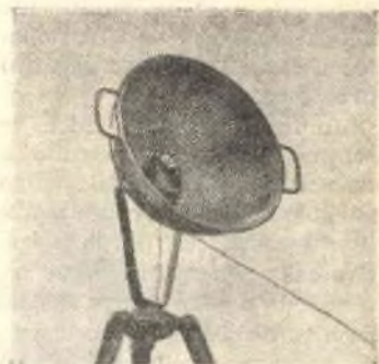
Fig. 5. - Un vecchio colabrodo, anche se esteticamente discutibile, può servire come riflettore.
